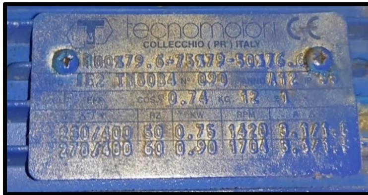
**Figure 2.50 :** Les caractéristiques du moteur de convoyeurs
