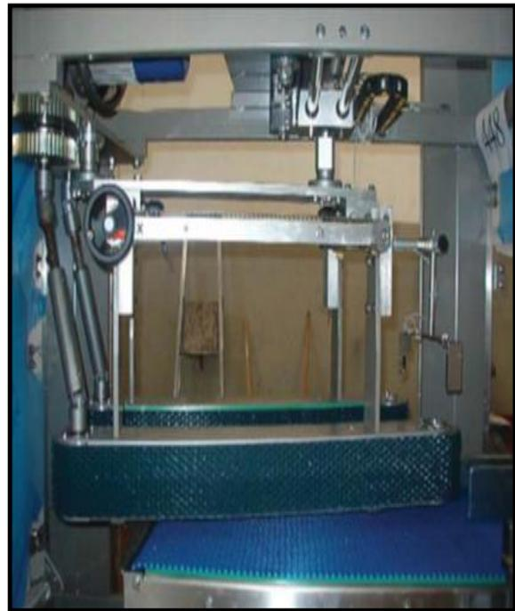
**Figure 2.3** : Les deux convoyeurs du diviseur
