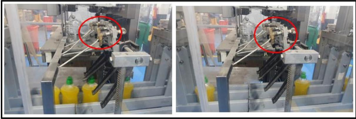
Figure 2.9 : Les trois capteurs Ci\_4,5,6
