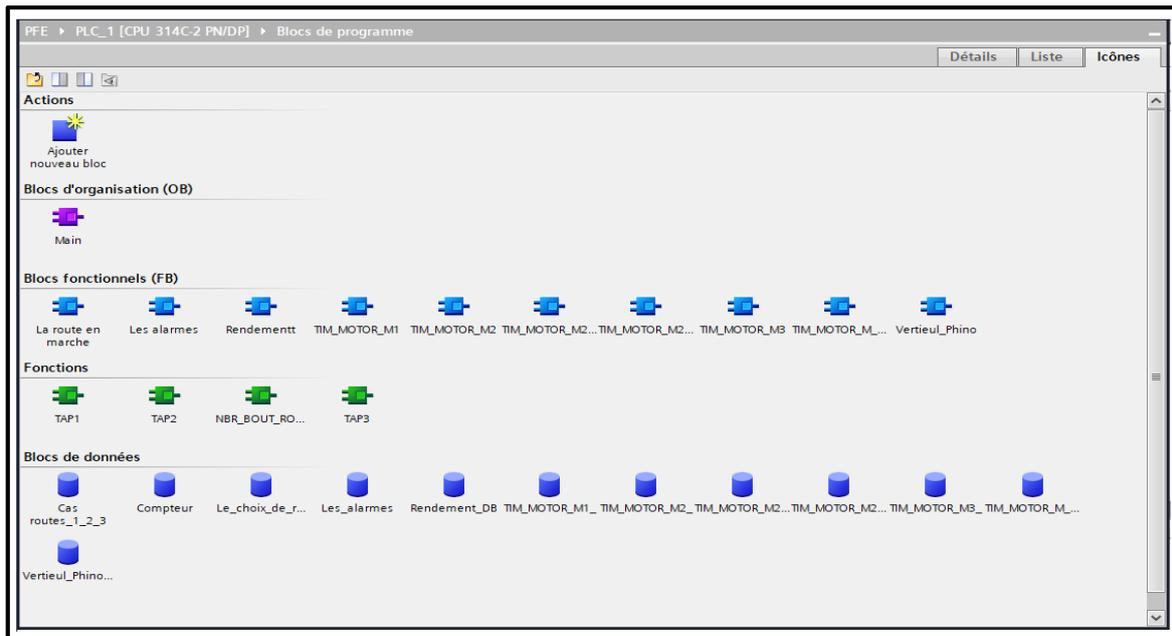
Figure 4.2 : Fonctions FC, FB et bloc data DB utilisé en programmation
