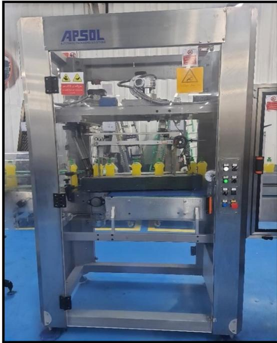
**Figure 2.2** : Diviseur de voie des bouteilles
