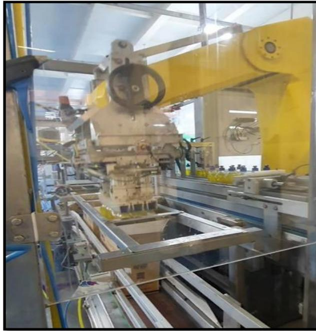
**Figure 2.17** : Dépôt des bouteilles dans la boîte
