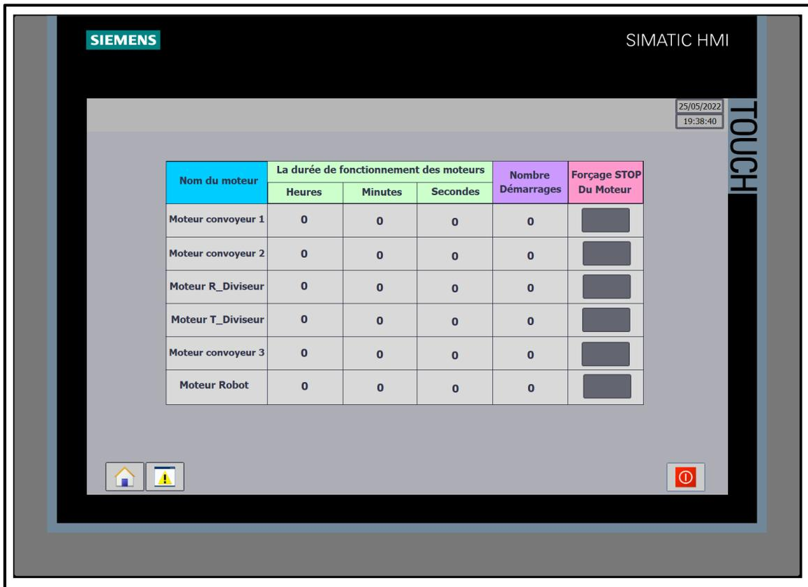
Figure 4.34 : La vue "Paramètres Moteurs" de l'IHM
