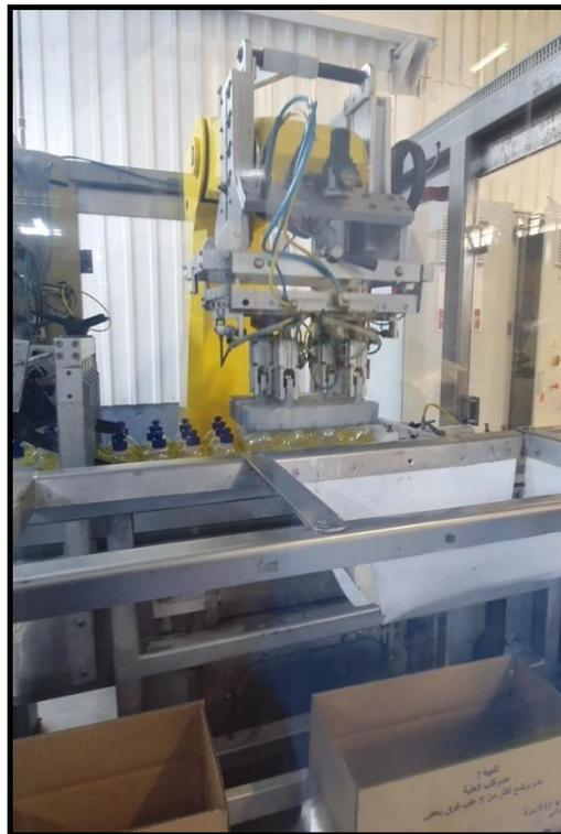
**Figure 2.16** : Fermeture des pinces sur les 12 bouteilles
