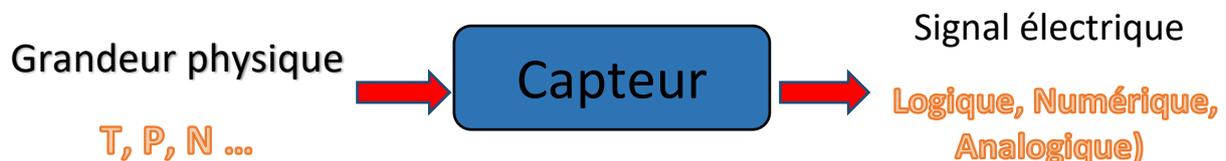
Figure 3.10: Schéma fonctionnelle d'un capteur
