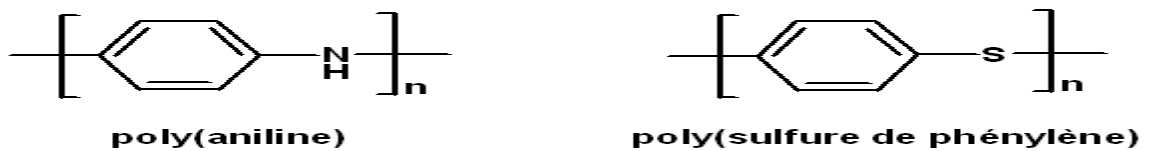
Figure I.6 : Des Polymères conducteurs possédant des hétéroatomes dans leurs chaînes principales [3].
