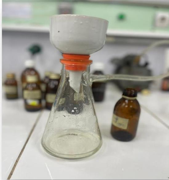
**Figure 3.5 :** Dispositif de filtration
