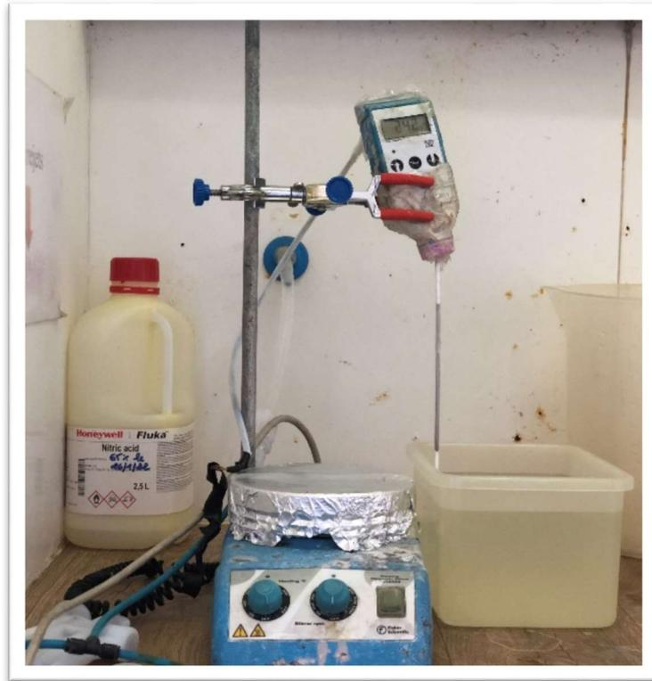
**Figure III. 2** Image de la manipulation du process de texturisation par voies acide (photo prise au sein du Laboratoire CRTSE)
