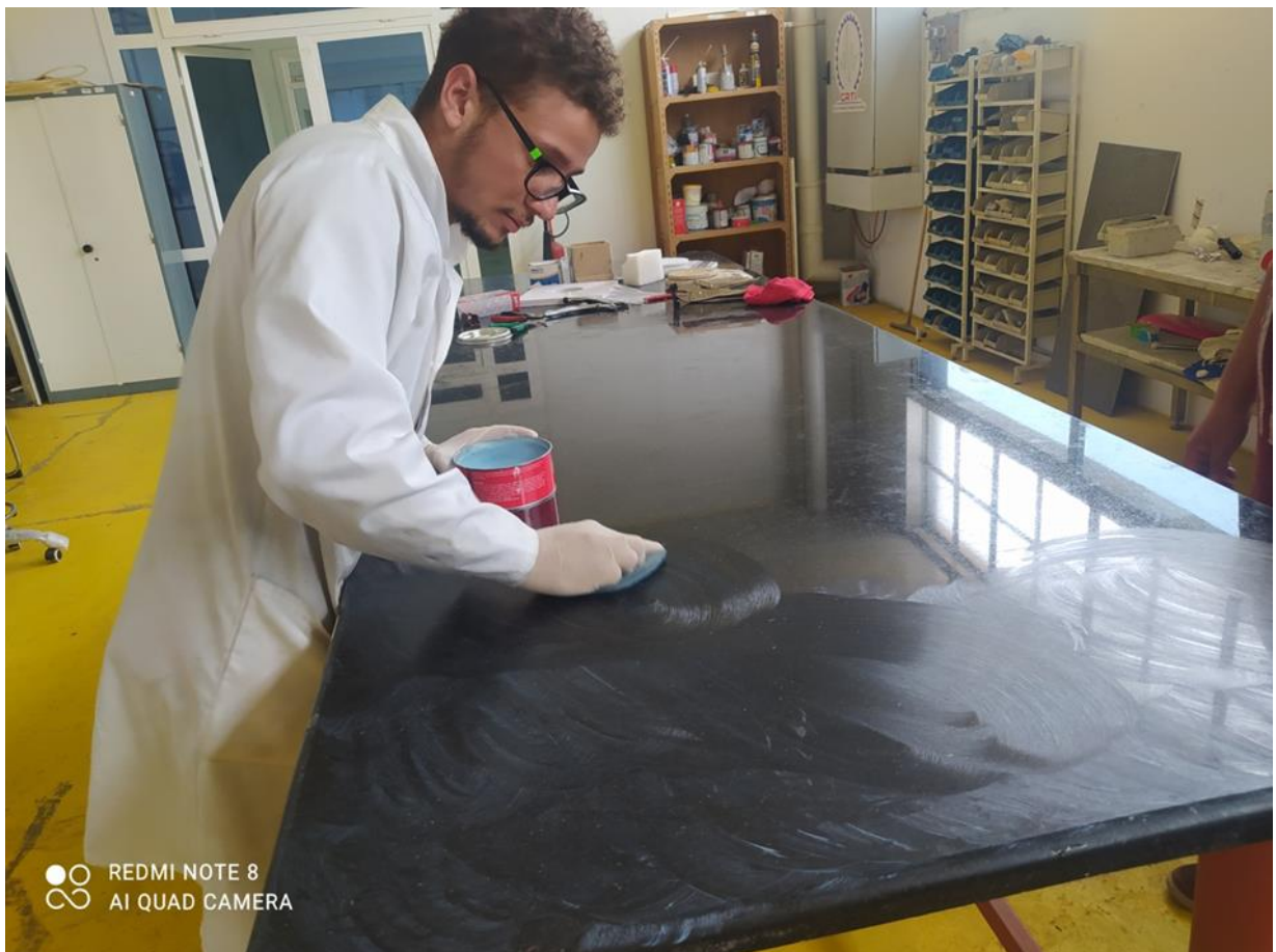
Figure IV-11 Cirage le moule avec une cire de démoulage.
