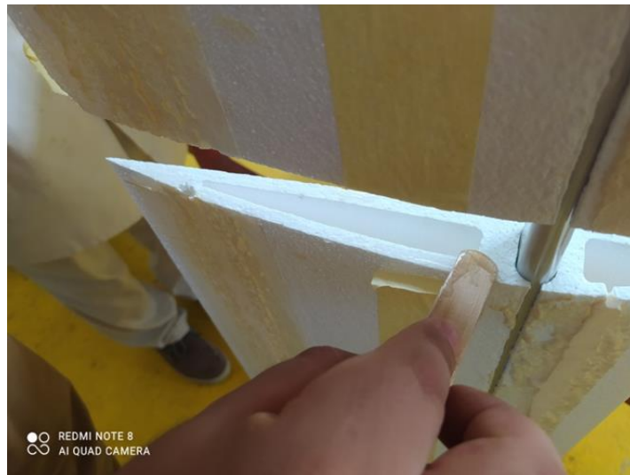
Figure IV-32 Raccordement les quatre parties de l'aile.
