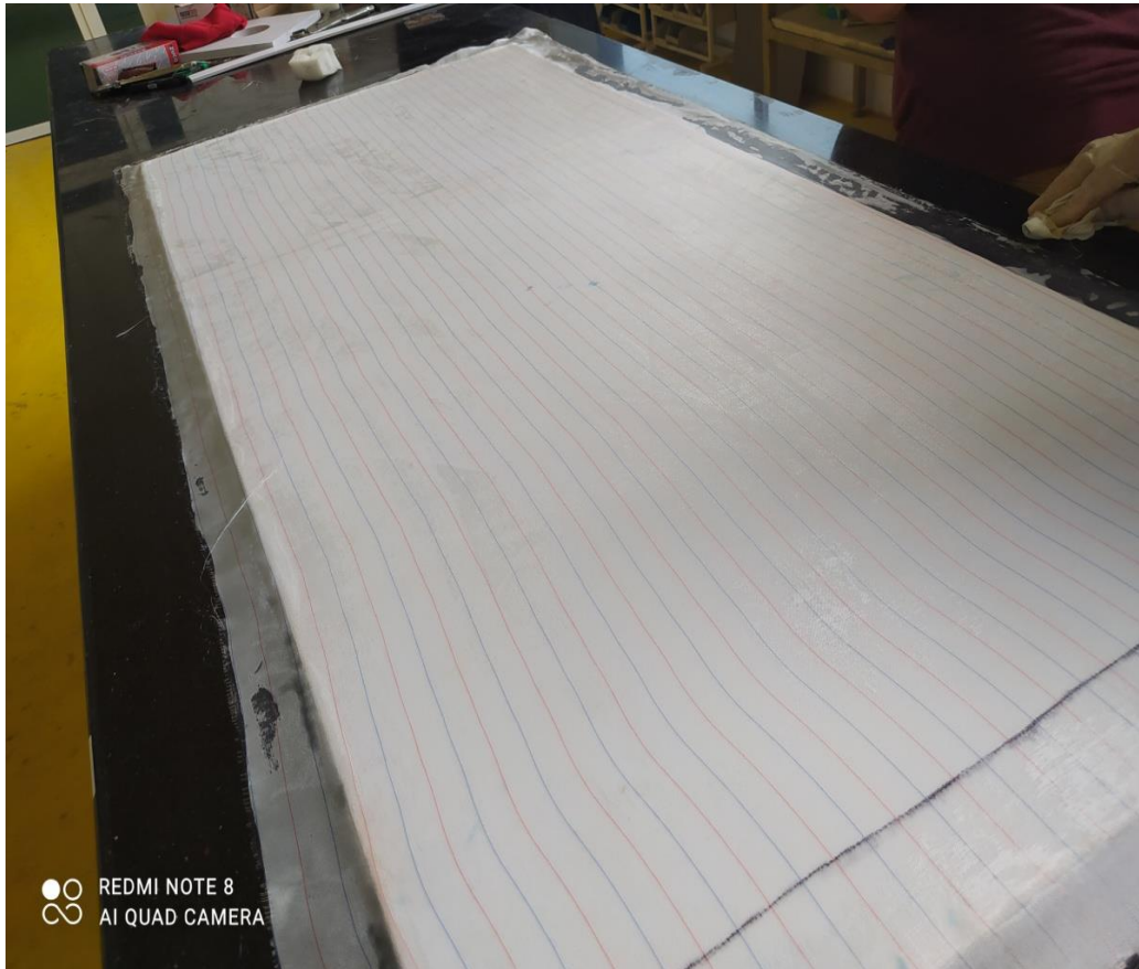
Figure IV-17 Posons le tissu d'arrachage.
