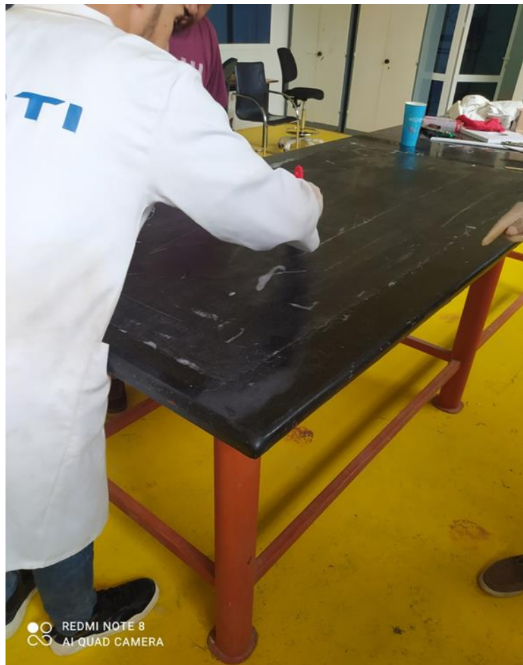
Figure IV-14 la première couche de fibres de verre.
