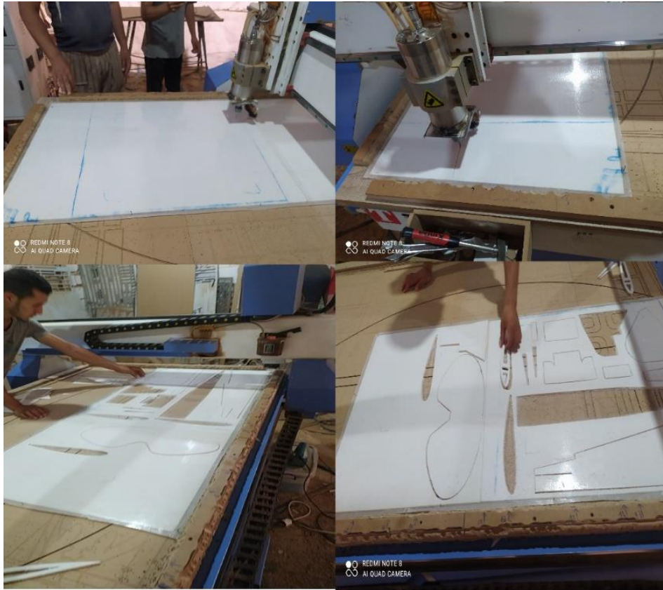
Figure IV-24 Découpage les pieces par CNC.
