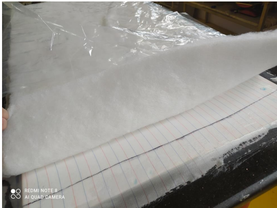
Figure IV-19 Mise en ouvre la bâche à vide et la fermeture.
