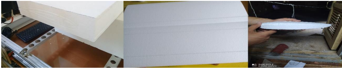
Figure IV-29 La découpe de l'aile en (04) parties
