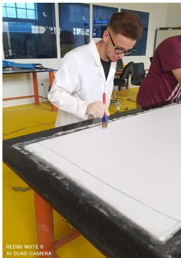
Figure IV-16 La deuxième couche de fibre de verre +résine epoxy
