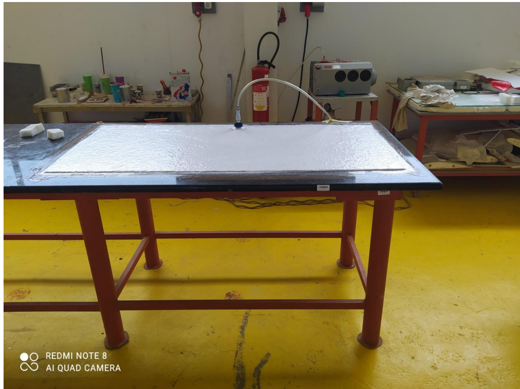
Figure IV-20 Mise en place de la prise de vide.
