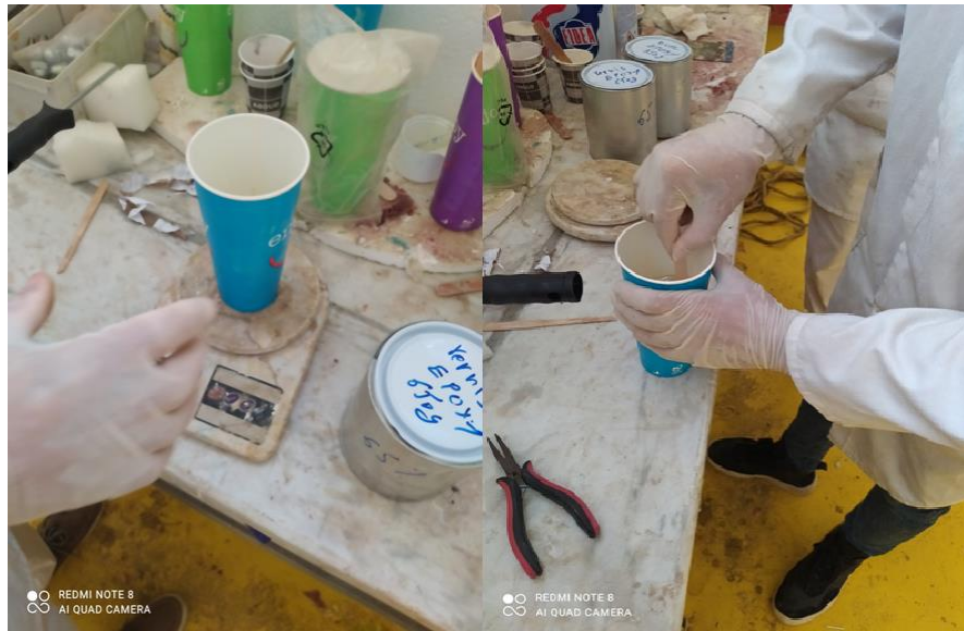
Figure IV-13 Préparation de résine époxy.
