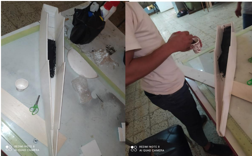
Figure IV-26 Revêtement de l'intérieure de fuselage en composite (fibre de carbon+résine epoxy).
