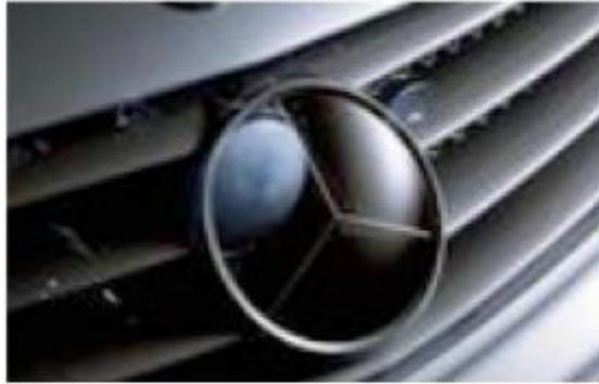
**Figure I.14:** Capteur radar DISTRONIC [5]
