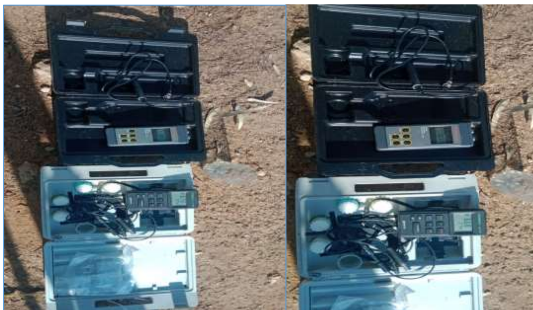
Fig.32 : Ph mètre et conductivimètre de l'ANRH utilisée pour les mesures sur terrain
