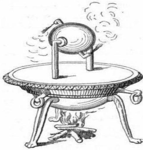
**Figure I.2 : chaudière l'éolipile par Héron d'Alexandrie**
