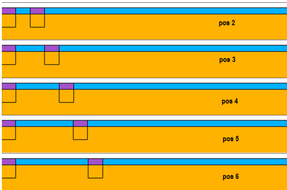
Figure 3.1. Les différentes structures présentant le positionnement du premier anneau de garde simulées avec l’outil ATLAS de SILVACO.
