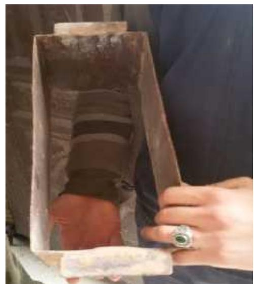
Fig.19 : moule d'une brique d'adobe
