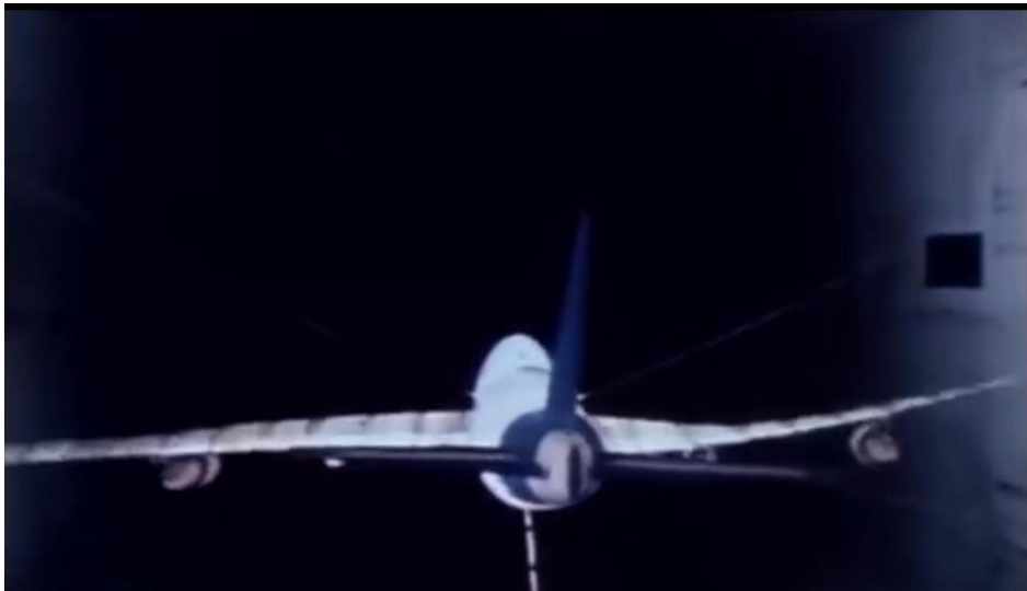
Figure I-1 : Développement de flottement sur les ailes d'une maquette d'avion
