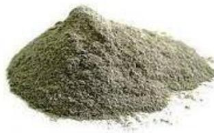
Figure I .11 : Argile de bentonite
