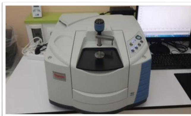
Figure II.5 : Photo représentant le spectrophotomètre ATR-FTIR.
