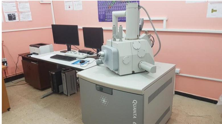
Figure 2.28 : Microscope électronique à balayage QUANTA 650.
