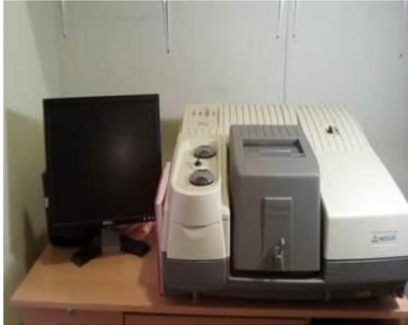
Figure 2.30 : Spectroscopie infrarouge à transformée de Fourier (FTIR/ATR) Thermo Nicolet NEXUS 670\_CRTSE
