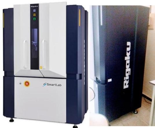
Figure 2.25 : Diffractomètre à rayons X Rigaku SmartLab SE.
