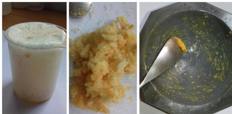
Figure 2.11 : le gel sec obtenu et l'étape de broyage.
