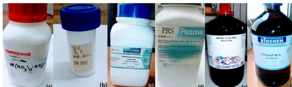
Figure 2.8 : Précurseurs utilisés pour la synthèse d' $Y_3Al_5O_{12}$  par les deux méthodes : (a)  $Al(NO_3)_3 \cdot 9H_2O$ , (b)  $Y_2O_3$ , (c)  $NH_4HCO_3$ , (d)  $C_6H_8O_7$ , (e)  $HNO_3$ , (f)  $C_2H_6O$
