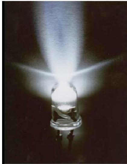
Figure 1. 15 : Photographie d'une diode blanche réalisée à partir d'une diode bleue et de YAG:Ce<sup>3+</sup> [7].
