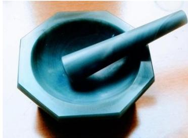
Figure 2.4: Mortier et pilon en agate.
