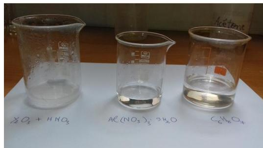
Figure 2.9 : Les solutions aqueuses intervenant dans la synthèse par la voie sol-gel.
