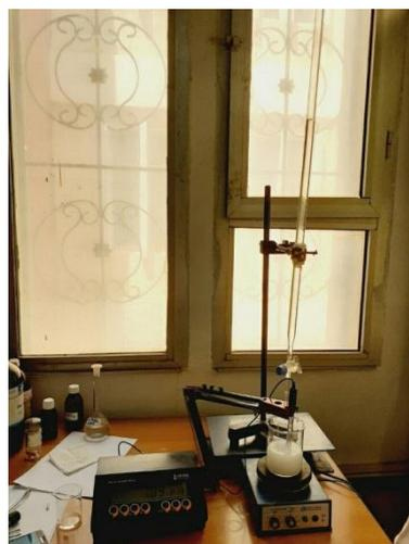
Figure 2.16 : dispositif expérimental utilisé pour la synthèse de YAG par Co-précipitation inverse.
