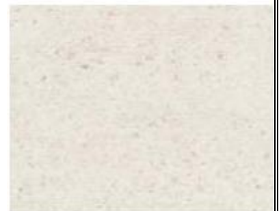
"Fermacell" plaque de gypse renforcé de papier recyclé pour cloisons isophoniques et coupe feu
