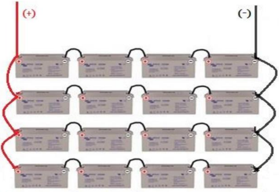
Figure III-12 : Connexion de notre parc batterie. (Alger et Batna)
