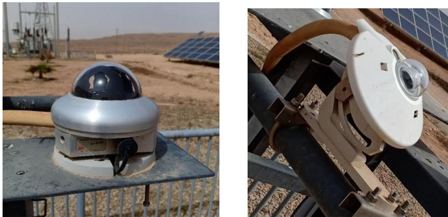
Figure 2-29 : Pyranomètres.
