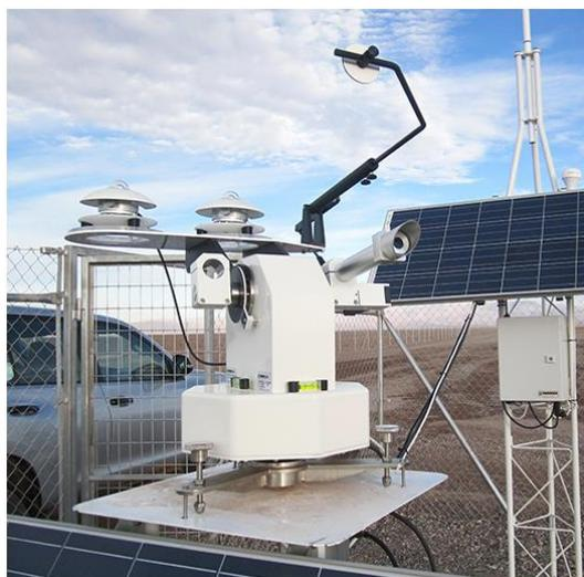
Figure 1-14 : Station de mesure météorologique.
