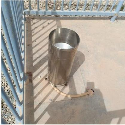
Figure 2-31 : Capteur de la quantité de pluie.
