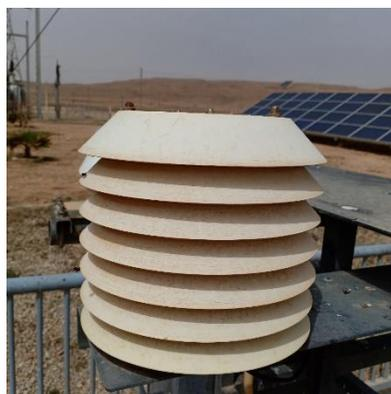
Figure 2-30 : Capteur d'humidité en bas.
