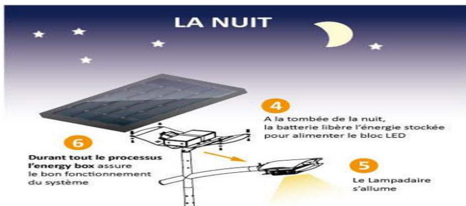
Figure II. 3:Principe de fonction d'éclairage public solaire pendant dans la nuit
