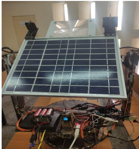
Figure 3-14 : le système De Fresnel et le traquer solaire alimentée par un panneau photovoltaïque.
