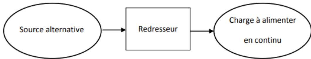
Figure (II.1) : convertisseur alternatif-continu (Redresseur)
