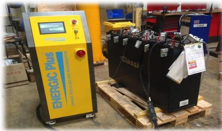
Figure (III-4): régénération des batteries de traction.
