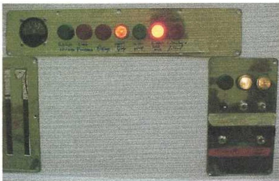
Figure 4-42 : Interrupteur batterie sur marche.
