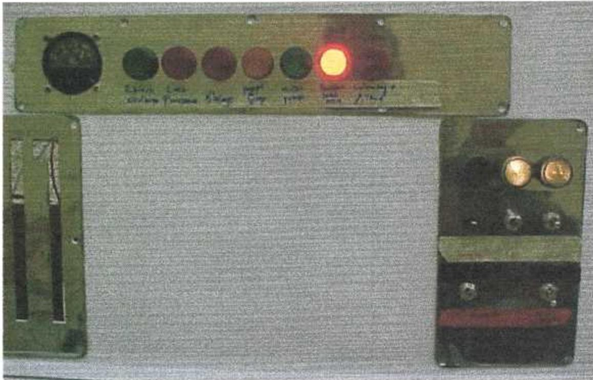
Figure 4-43 : L'interrupteur pompe de gavage sur la position marche.
