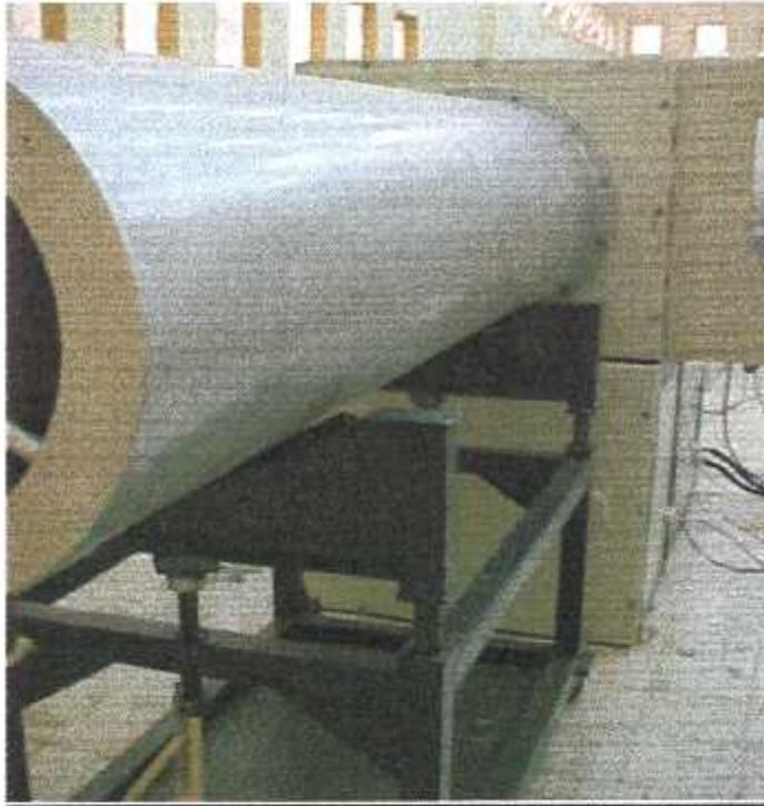
Figure 4-14 : La fixation du silencieux sur le bâti.
