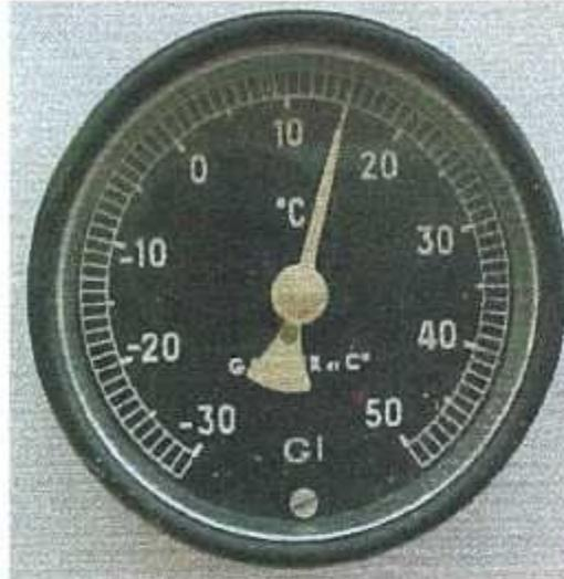
Figure 4-23 : Thermomètre.
