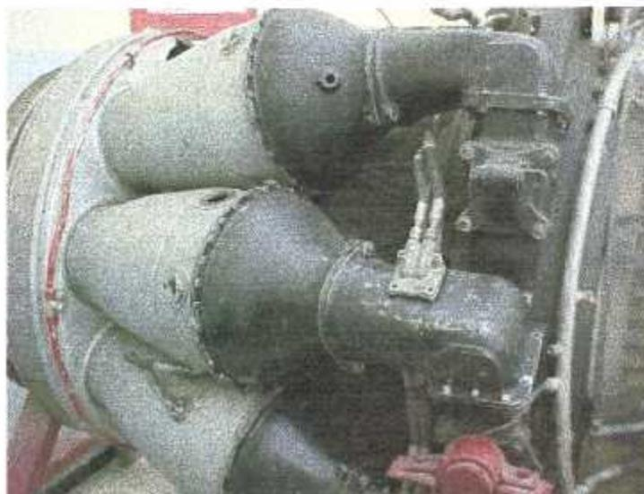
Figure 1-14 : Chambre de combustion tubulaire.
