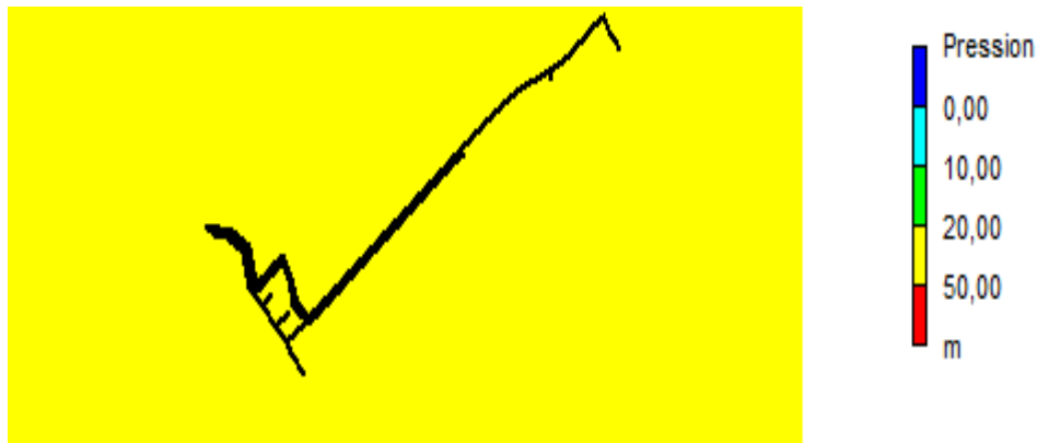
Fig.IV. V. Chaiba - Tektaka - Etat des pressions pendant la période de pointe, (2050)
