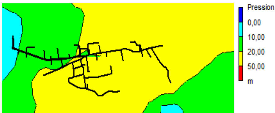
Fig.IV. XI. Chaiba - Centre-ville - Etat des pressions pendant la période creuse, (2050)
