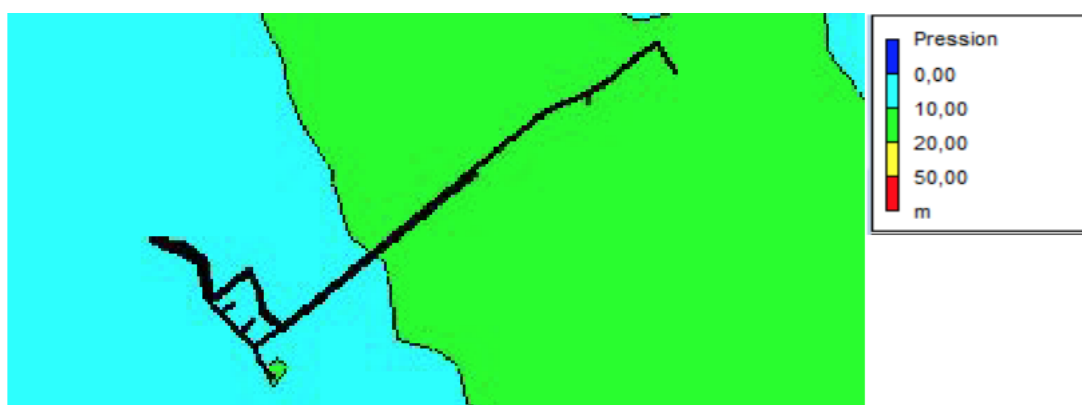
Fig.III 26. Chaïba – Tektaka – État des pressions pendant la période creuse, (2020)
