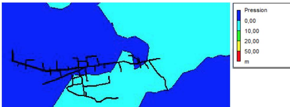
Fig.III 24. Chaiba – Centre-ville – Etat des pressions pendant la période creuse, (2020)
