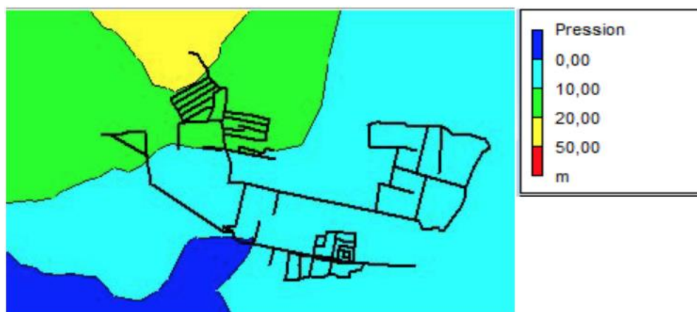
Fig.III 22. Chaïba – Chaigh – État des pressions pendant la période creuse, (2020)
