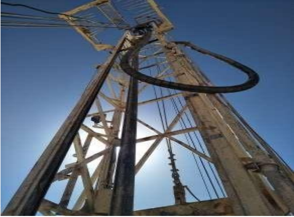
Fig.19 : Tige d'entraînement (forage de larbàa)
