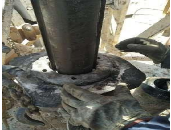
Fig.19 : Tige d'entraînement (forage de larbàa)
