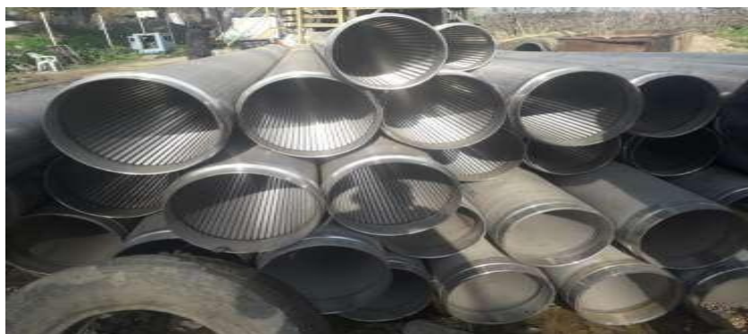
Fig 27 : Crépines de Johnson (forage de l'arbaa)
