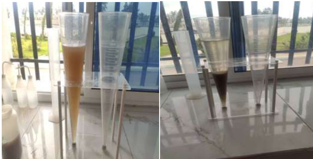
Figure IV.5: Cônes D'Imhoff Source : [STEP de Beni Mered]
