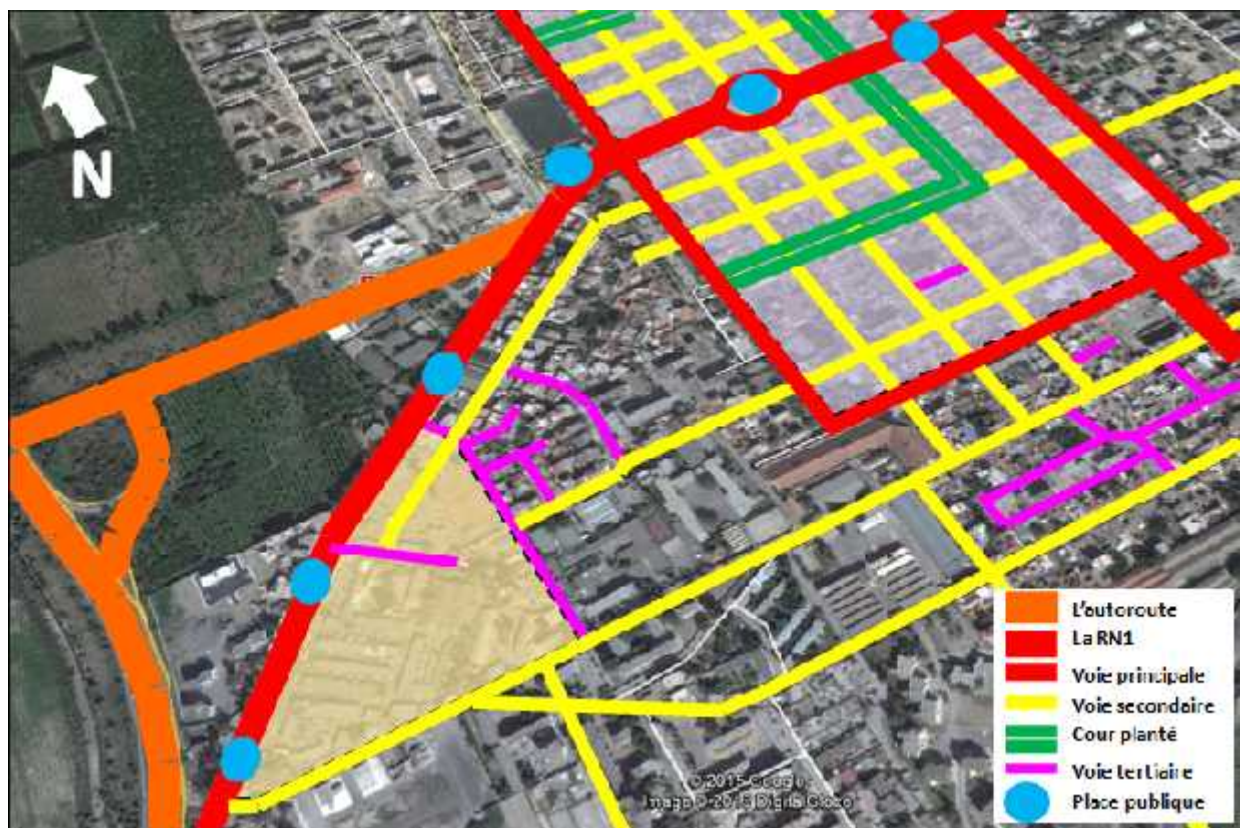
Figure 3.59 : Schéma de l'hierarchisation des voies existantes et le rythme des places publiques
