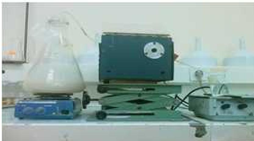
Figure II.2 : Schéma représente la préparation de montm-Al<sub>13</sub>
