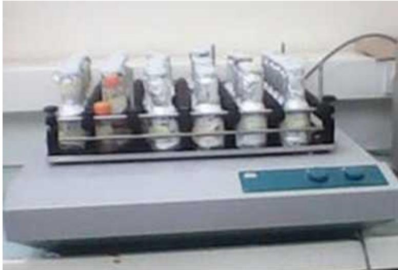
Figure II.4: Photo de secoueur utilisé
