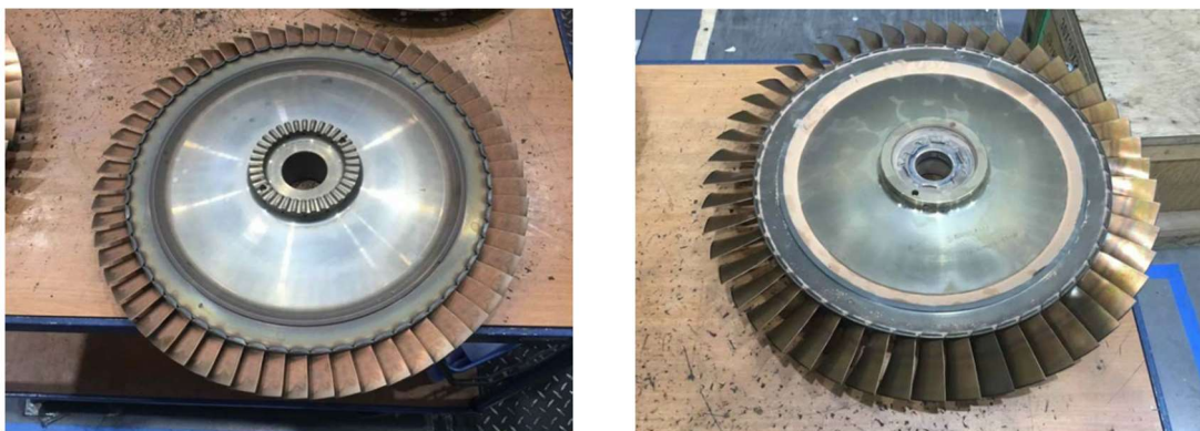
Figure 2.14 : 1er et 2eme étages de la turbine génératrice de gaz
