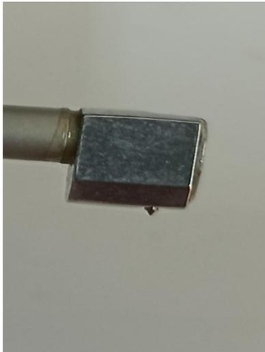
Figure 41: palpeur pointe en diamant de 5  $\mu\text{m}$
