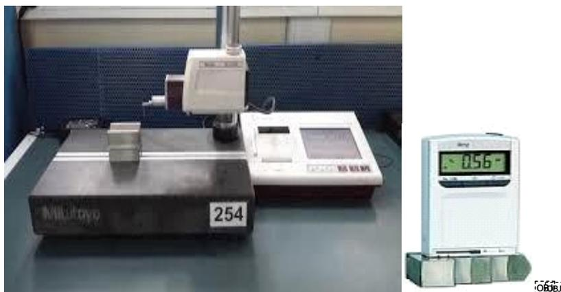
Figure 26: Rugosimètre[12].
