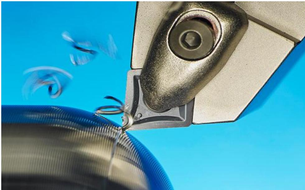
Figure 38: l'enlèvement de matière avec pc8110
