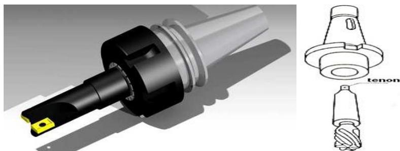
**Figure I.7 :** Montage de fraises
