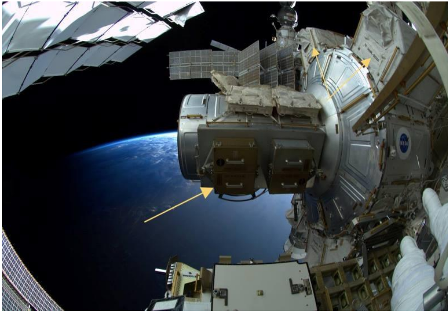
Figure 22 : Boîtes à outils et réservoirs du Quest, montrés par des flèches. [49]
