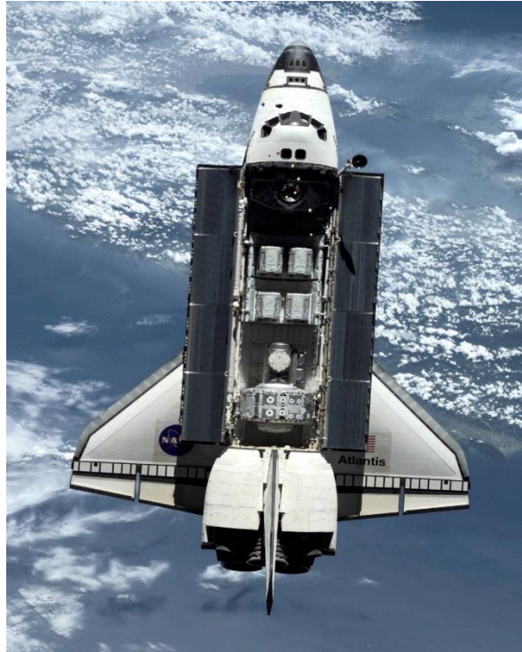
Figure 51 : Vue sur la façon dont Quest est posé dans la navette.
