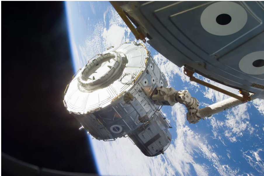
Figure 16 : Le module Quest transféré par le bras robotique Canadarm vers sa position d'amarrage, pris durant STS 104. [39]
