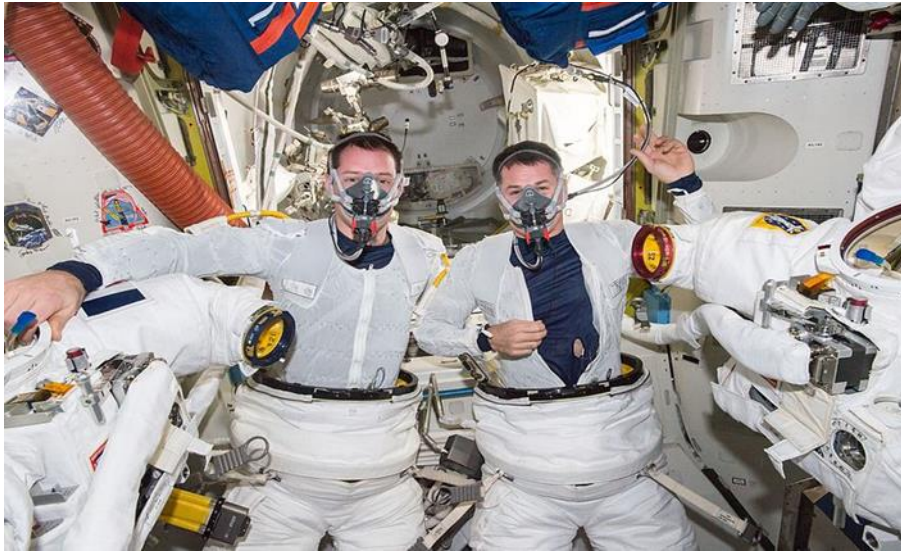
Figure 19 : Deux astronautes entrain de pratiquer la pré-respiration avant une sortie extra véhiculaire. [46]
