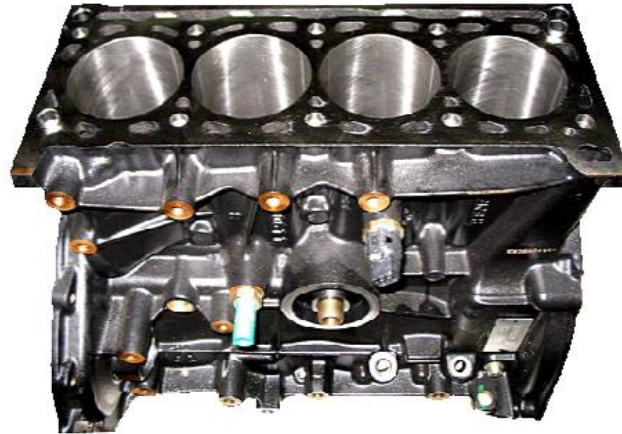
Figure I.3 : Le bloc-cylindres et la chemise [1]
