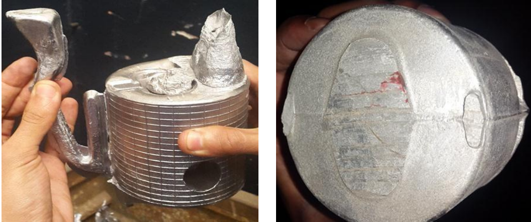
Figure III.6 : Opération de démasselottage
