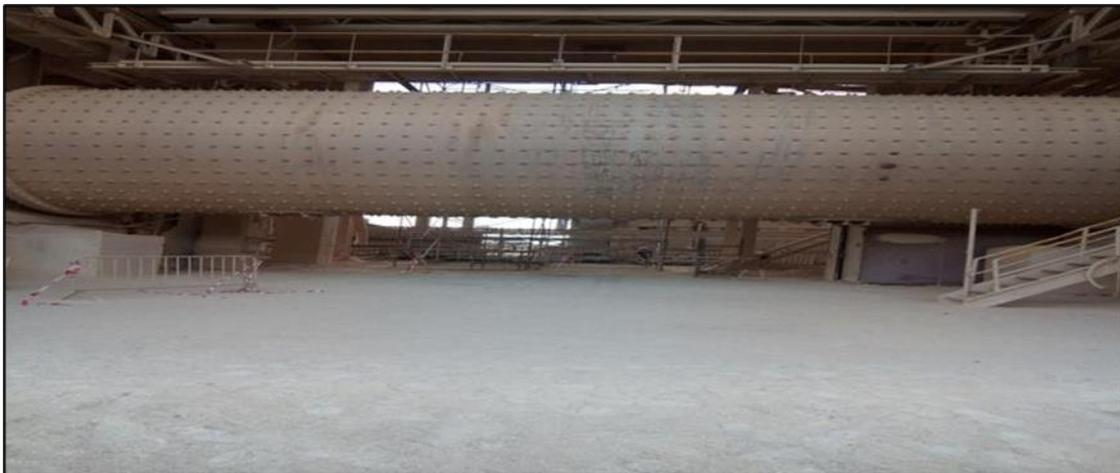
**Figure I.10 : broyeur a boulet.[14]**
