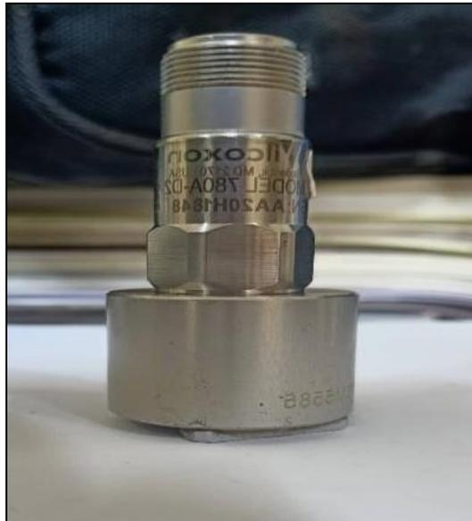
**Figure. IV.11** Accéléromètre utilisé.
