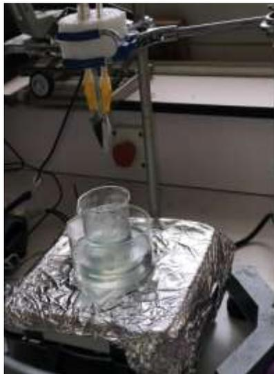
Figure 2-4: La cellule électrochimique utilisé pour l'électrodéposition.
