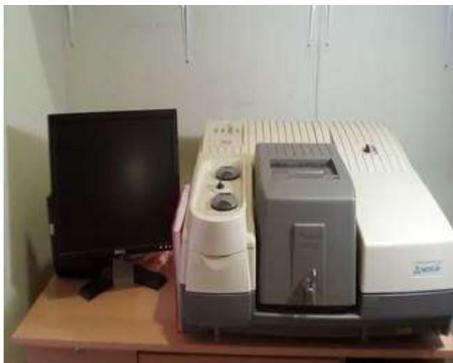
**Figure 2-11** : Spectroscopie Infrarouge à Transformée de Fourier (FTIR/ATR) Thermo Nicolet NEXUS 670 (CRTSE)
