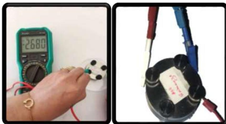
**Figure 3-10** : Une cellule Swagelok ZnO/CuO-Li à deux électrodes avec un potentiel de -2.68v.
