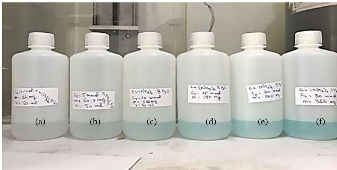
Figure 2-3: Solutions électrolytiques contenant 0,5 M ( $Zn(NO_3)_2$ ) + X ( $Cu(NO_3)_2$ ), X = 1mM (a), 5mM (b), 10mM (c), 15mM (d), 20mM (e) et 30mM (f) respectivement.
