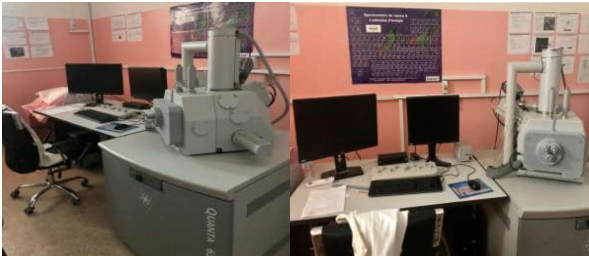
**Figure 2-13 :** Microscope Électronique à Balayage (MEB) couplé à une Sonde d'analyse Dispersive en Énergie (EDS), Quanta 650, (laboratoire PUNDAPL-USDB1).
