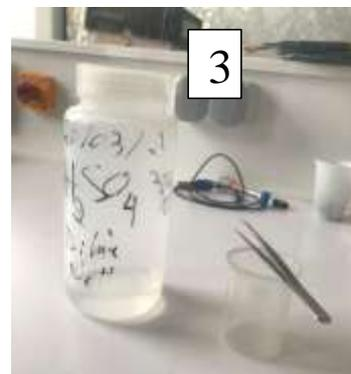
1. Nettoyage pendant 10 min dans la solution acide ( $H_2SO_4 + 6 H_2O$ )
