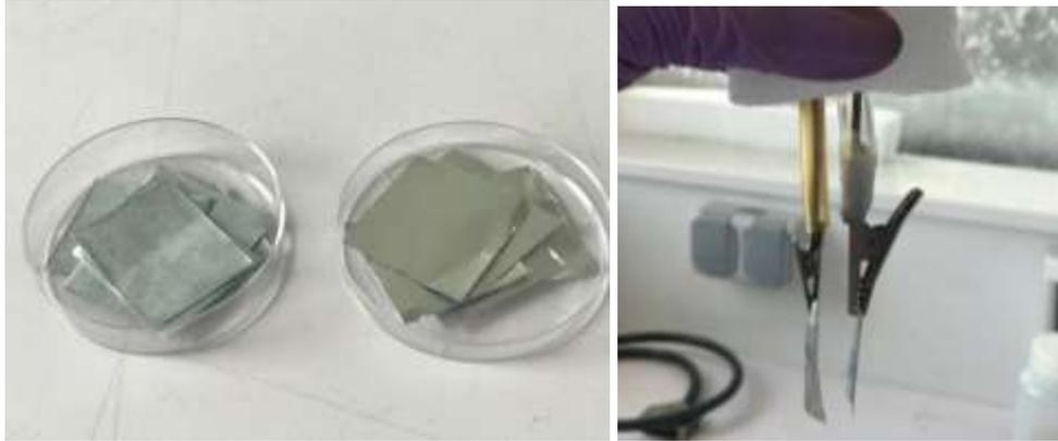
Figure 2-5 : Électrode de travail (plaque d'aluminium) et contre électrode (plaque de zinc)
