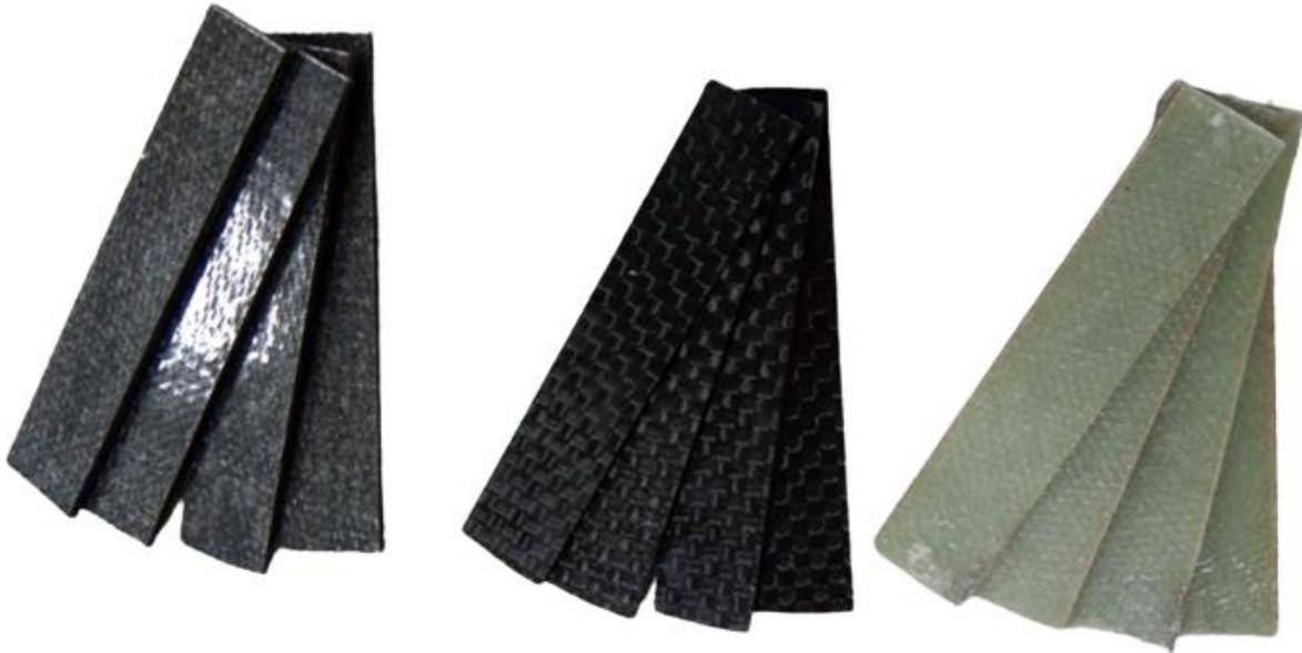
**Figure 2.15 : Les éprouvettes pour l'essai de flexion. De droite à gauche : éprouvettes en verre, éprouvettes en carbone, éprouvettes hybrides [3].**
