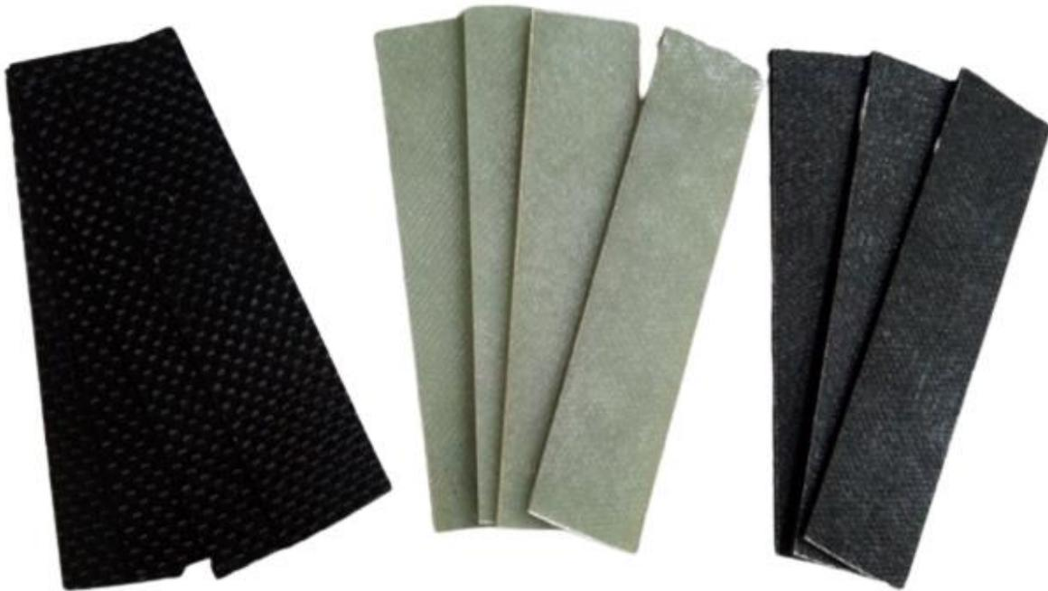
**Figure 2.14 : Les éprouvettes pour l’essai de traction. De droite à gauche : éprouvettes hybrides, éprouvettes en verre, éprouvettes en carbone [3].**
