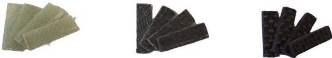
**Figure 2.16 : Les éprouvettes pour l'essai de cisaillement. De droite à gauche : éprouvettes en verre, éprouvettes hybrides, éprouvettes en carbone [3].**
