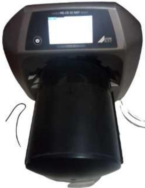
**Figure 3.4 : Scanner des films radiographiques ; nom de fabricant : Nürr NDT ; Type : HD-CR 35 NDT [3].**
