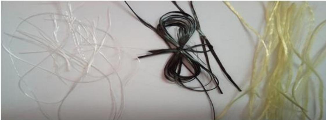
**Figure 1.6 : De gauche à droite : fibre de kevlar, fibre de carbone, fibre de verre [3].**
