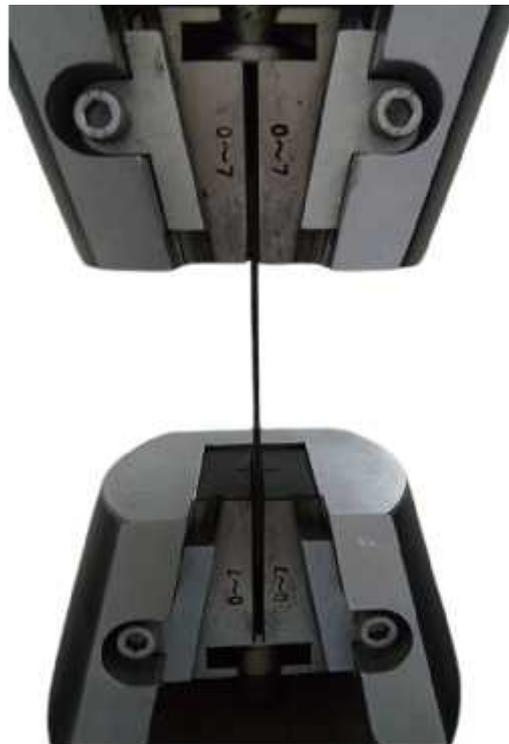
**Figure 3.6 : Eprouvette en carbone ajusté sur les mors de la machine de traction [3].**
