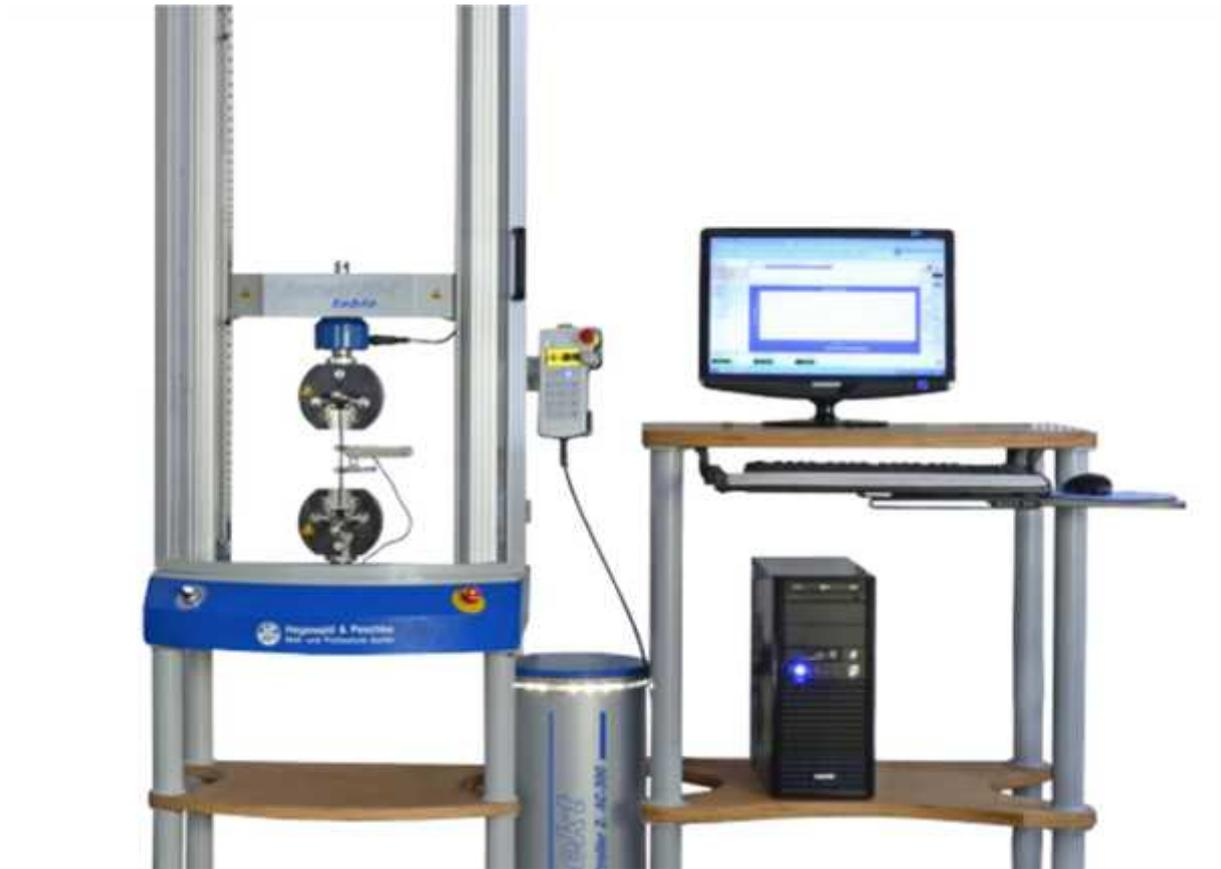
**Figure 3.1 : Machine TestWell des essais mécaniques [19].**
