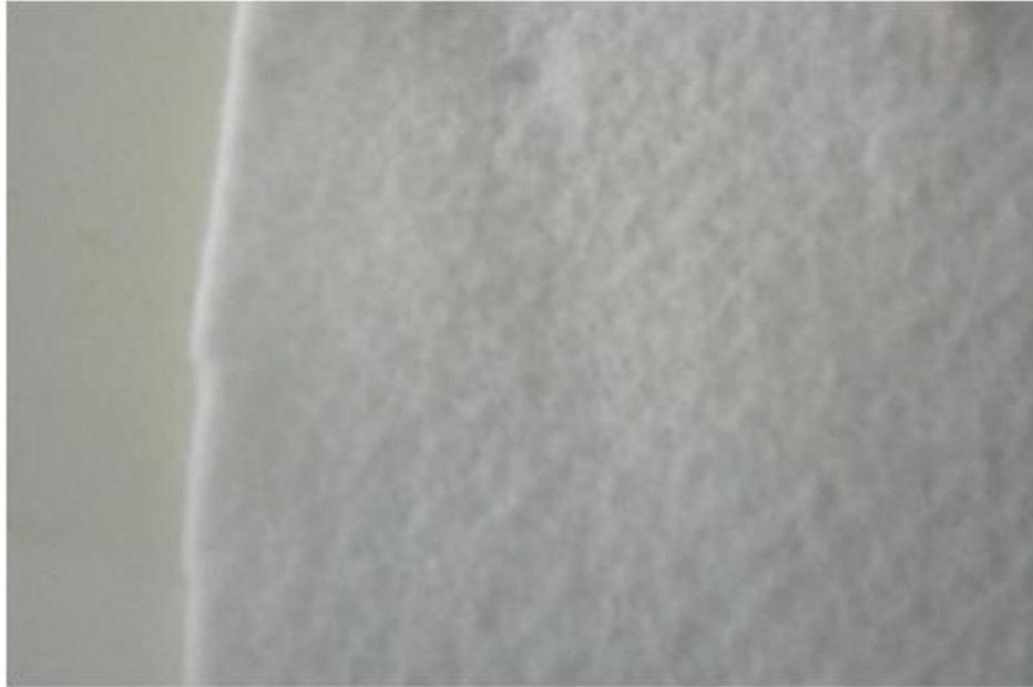
**Figure 2.9:** Le tissu de drainage, polyester felt, 330 g/m<sup>2</sup> (11.64 oz/ft<sup>2</sup>) [3].
