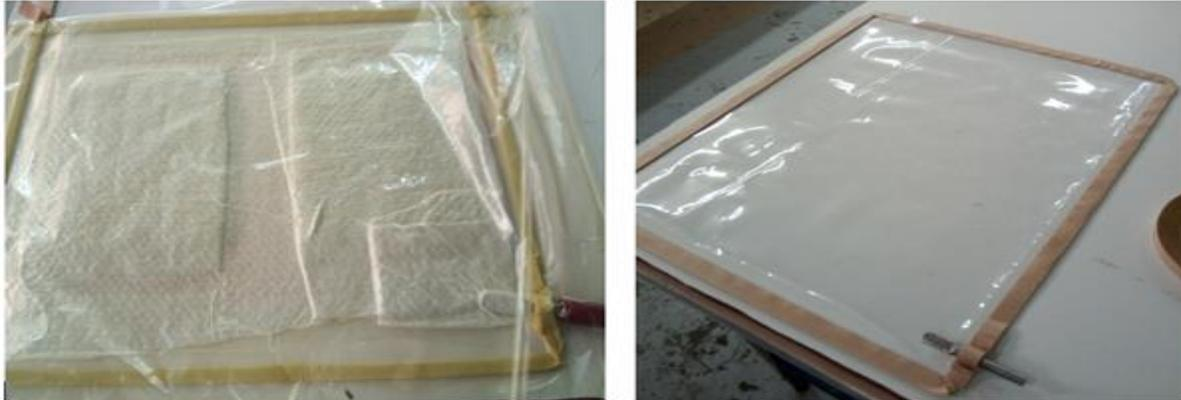
**Figure 2.12 : De droite au gauche : enceinte close vide, enceinte close branché avec la pompe à vide [3].**
