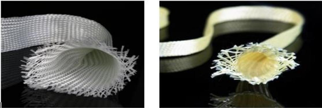
**Figure 1.11** : A droite, Maille tubulaire en fibre de verre de 60 mm de diamètre et 20 g/m linéaire. Idéal pour la fabrication de tubes ou de pièces tubulaires en fibre de verre utilisant des résines époxy polyester, uréthane-acrylique ou vinylester. A gauche, Tresse d'aramide (kevlar) tubulaire de diamètre 15 mm et 210 g/m<sup>2</sup>. Idéal pour la fabrication de tubes d'aramide avec des résines époxy et vinylester [9].
