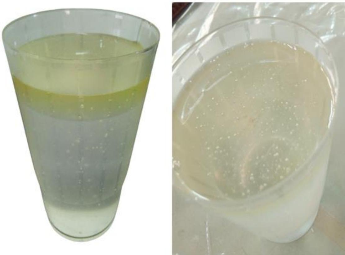
**Figure 2.13 : De gauche à droite, le durcisseur et la résine avant le mélange, le mélange résine-durcisseur [3].**
