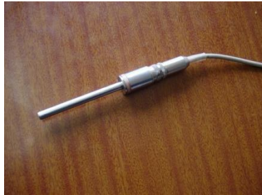
Fig II.13 : Capteur de phase (cellule photoélectrique SCHENCK)
