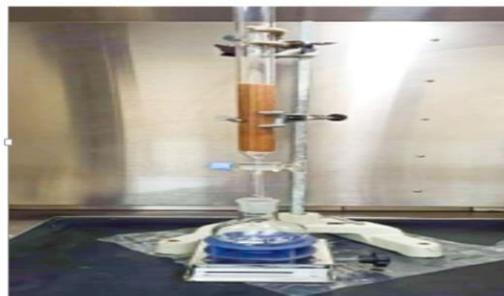
**Figure 14:** Protocol d'élimination d'huile contaminant le sable.
