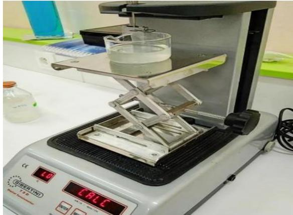
**Figure II.1.2.3:** technique de mesure de la TS à l'aide de tensiomètre.
