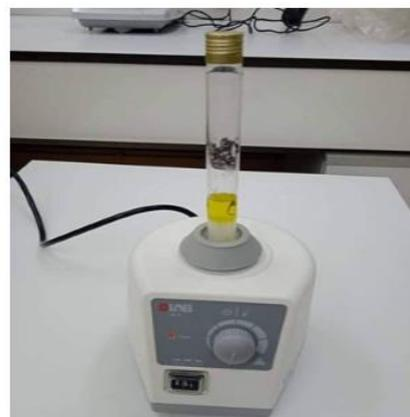
**Figure II.1.2.3 :** Agitation par vortex dans le test d'émulsification
