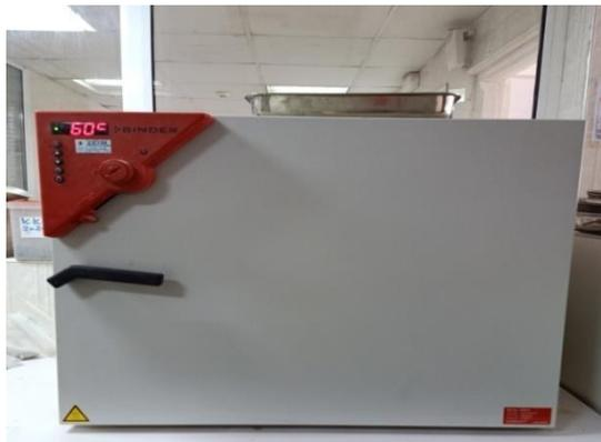
Figure III.7 : Etuve de séchage.
