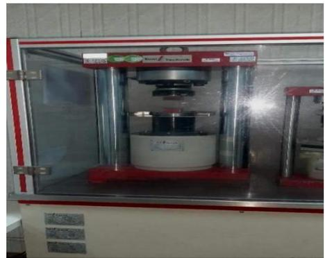
**Figure III.16 :** Appareil d'essais de Compression et de flexion.
