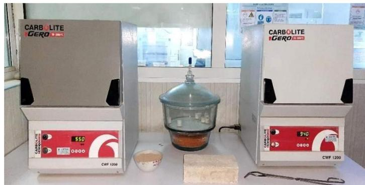
Figure III.8 : Four de calcination.
