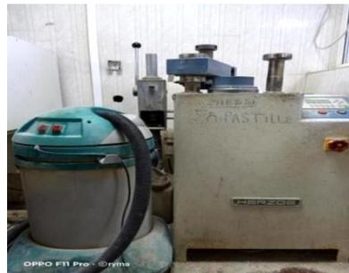
**Figure III.3 :** Pastilleuse d'échantillon.
