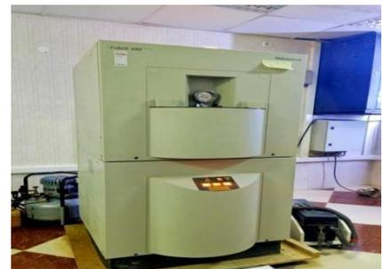
**Figure III.4 :** Appareil d'analyse XRF.
