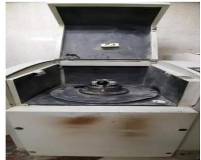
**Figure III.2 :** Broyeur à billes.
