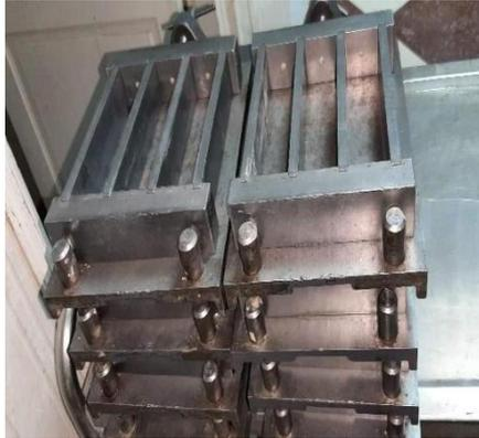
**Figure III.13 :** Moules d'éprouvettes.
