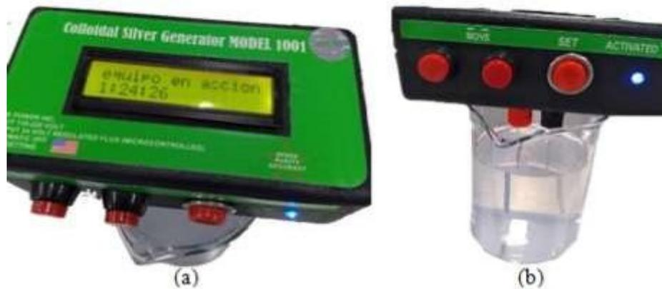
**Figure II.7 :** Système colloïdal, utilisé pour la synthèse ; AgNPs à température ambiante. (a) Générateur : argent colloïdal, (b) Solution de nanoparticules d'argent [26].
