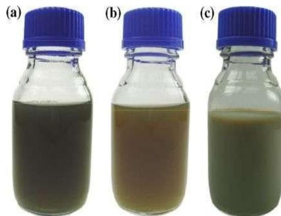
**Figure III.4 :** a : Décharge électrique, b : Méthode ECD (50 ppm de citrate de sodium) et c : Argent colloïdal Lee-Meisel [18].
