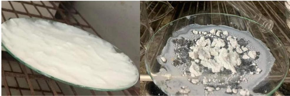
Figure II.5: HDL avant et après le séchage
