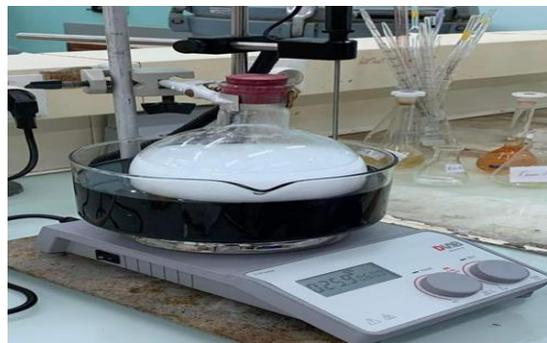
Figure II.3 :le montage à reflux
