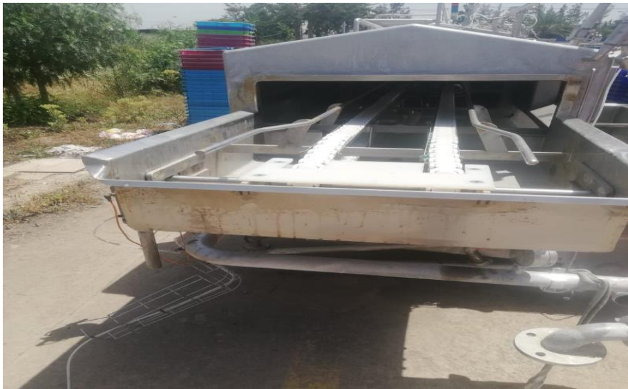
Figure 1.4 : Soulèvement et transfert des bacs par convoyeur
