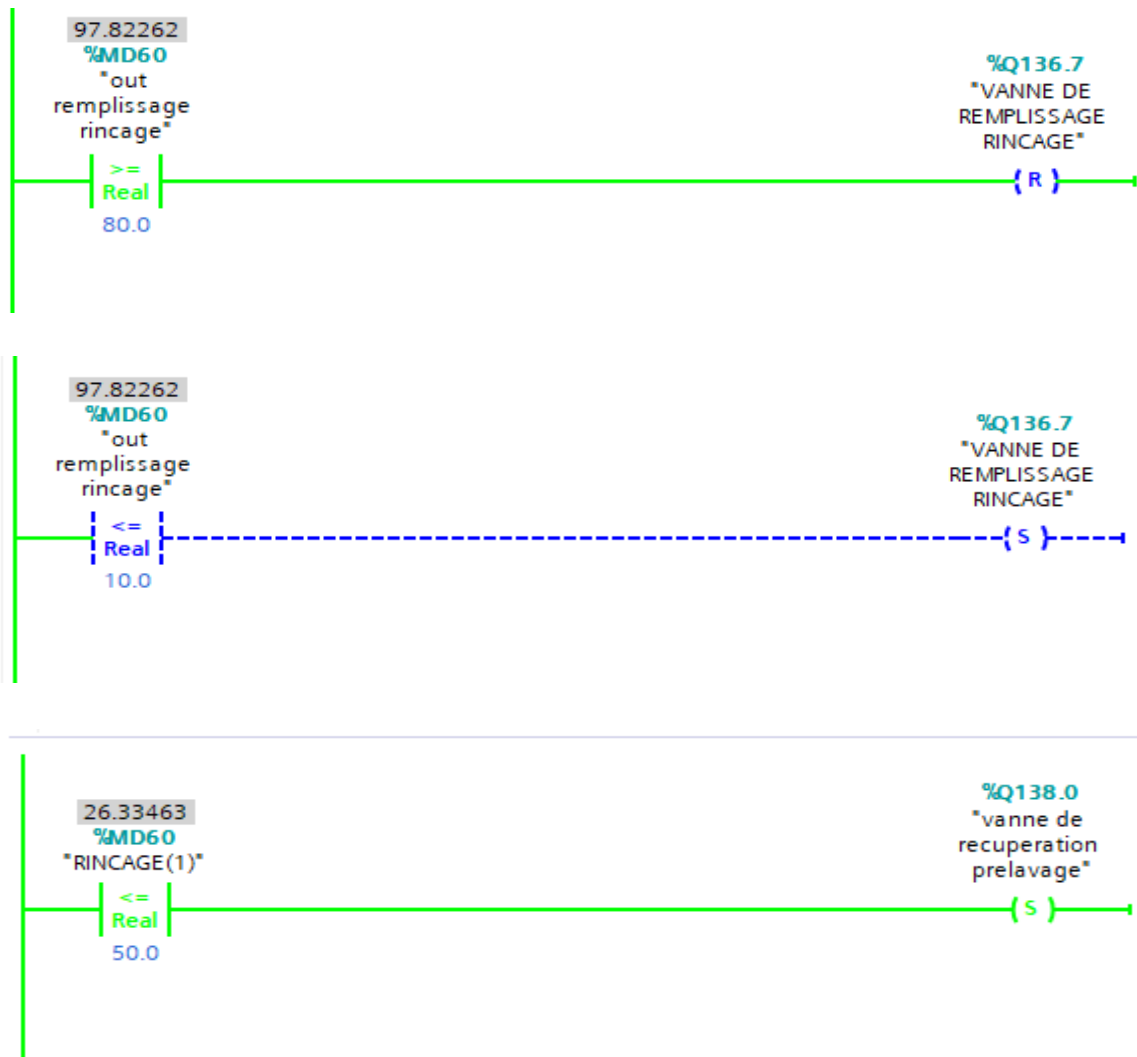
Figure 3.23 : programmation de vanne récupération et vanne de remplissage rinçage
