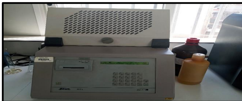
Figure III. 9: Appareil de mesure le facteur de dissipation (Tan \delta )
