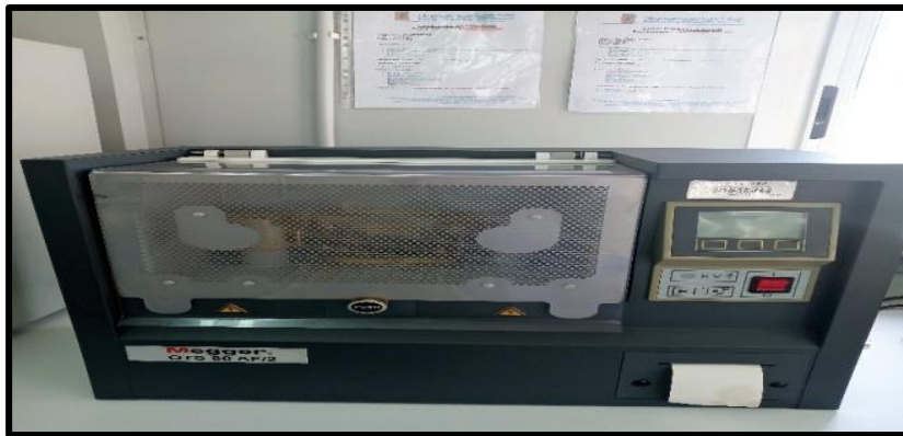
Figure III. 8: Appareil de mesure de la tension de claquage (spintermetre)
