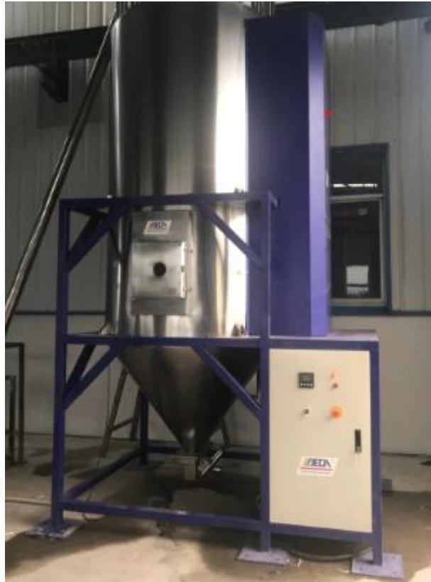
Figure II.4 : La trémie sécheur de PET
