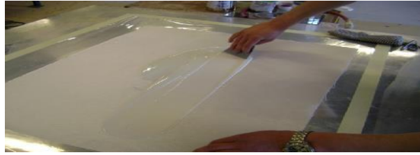
Figure III-12 : Dépôt de la résine sur le tissu de carbone
