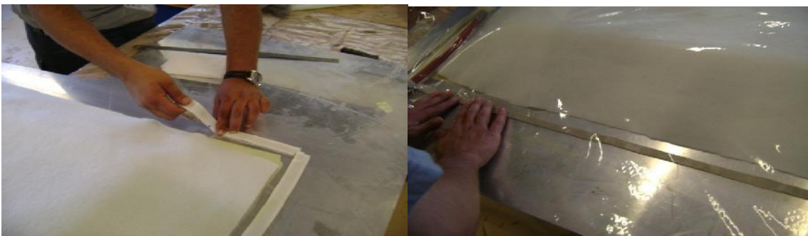
Figure III-18: Fermeture hermétique du sac à vide.
