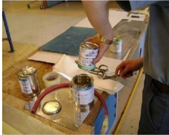
Figure III-9: Préparation de la résine type Epocast 50-A1 :
