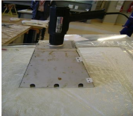
Figure III-22 : Placement du pistolet chauffant
