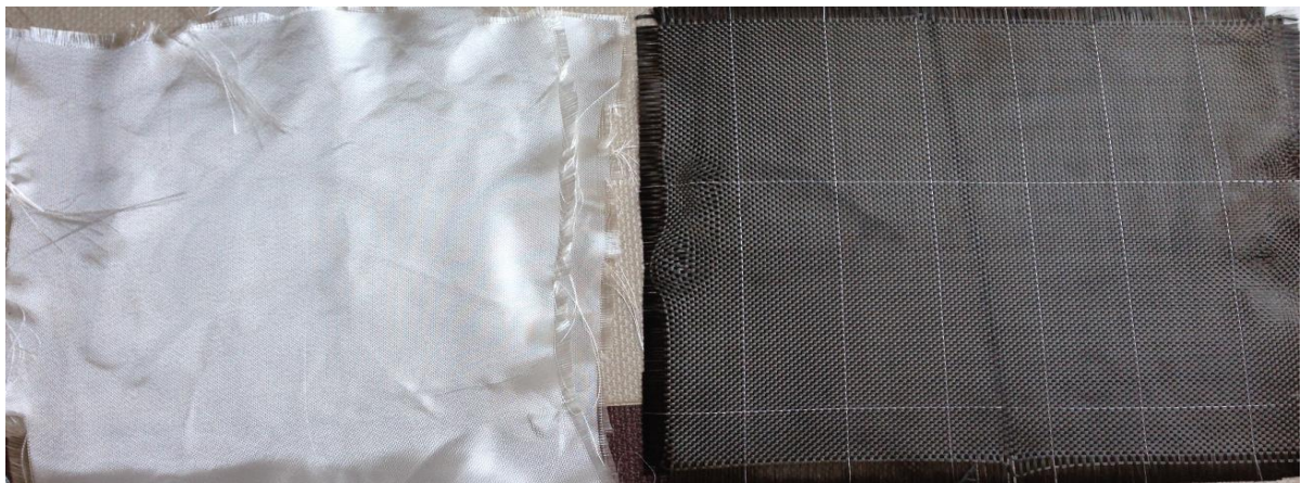
Figure III-4: Fibre de carbone/verre utilisé pour la conception des éprouvettes.
