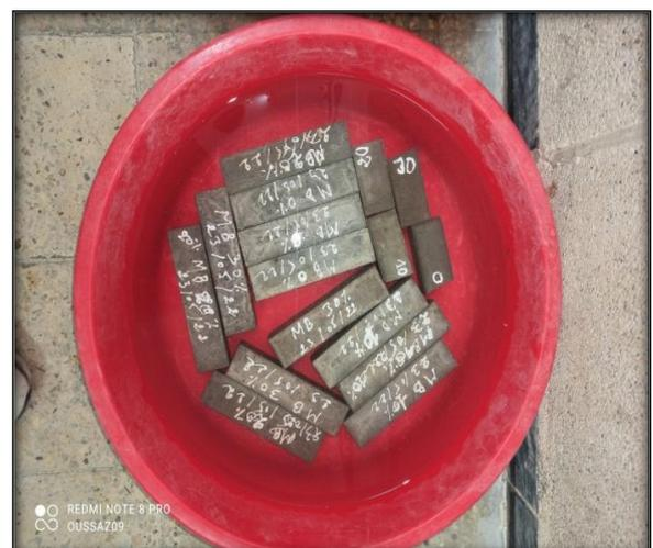
**Figure II. 13:** Conservation des éprouvettes.
