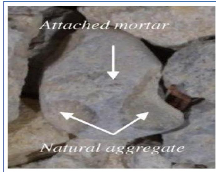
**Figure I. 9:** Composition des granulats recyclés de béton [42]
