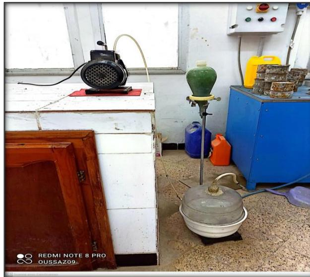
Figure II. 18: appareillage de l’essai de porosité accessible à l’eau
