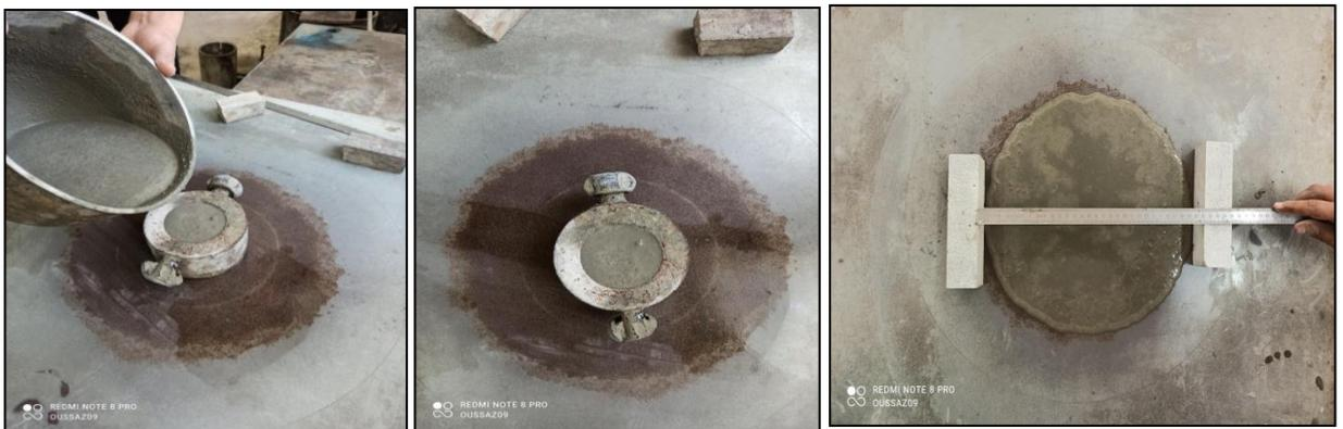
**Figure II. 9:** Etalement au mini cône.
