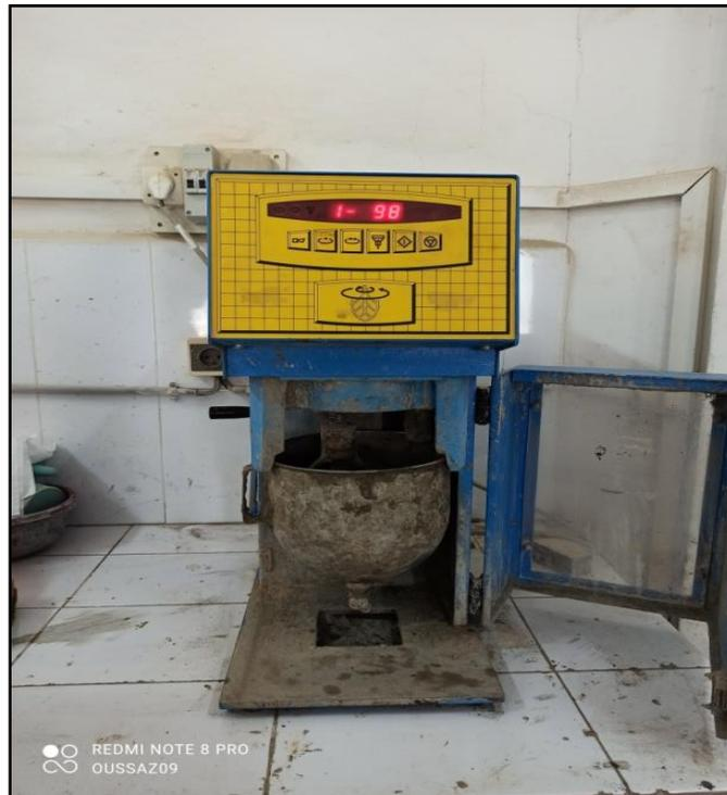
**Figure II. 8:** Malaxeur à mortier
