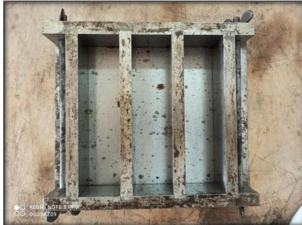
**Figure II. 12:** Moules prismatiques pour mortier
