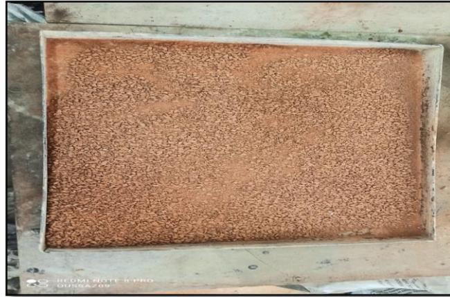
**Figure II. 6:** Sable de déchet de brique après concassage
