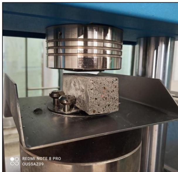
**Figure II. 15:** Essai de résistance à la compression
