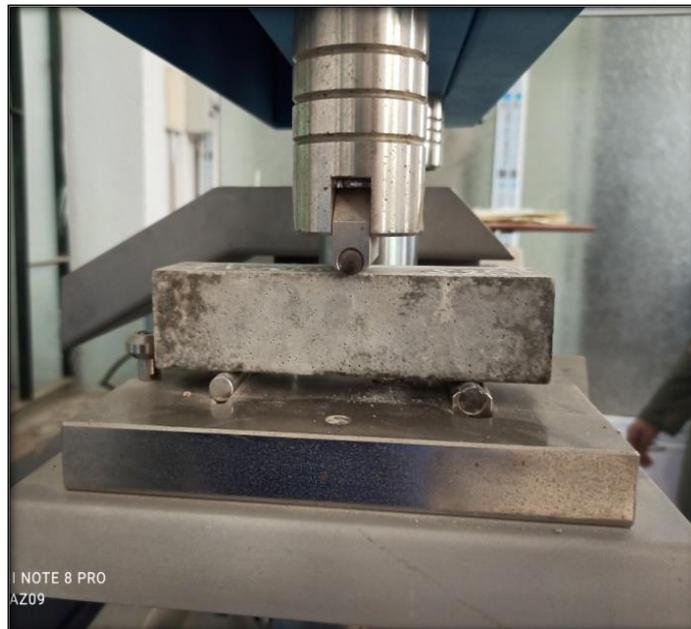
**Figure II. 14:** Essai de résistance à la traction par flexion
