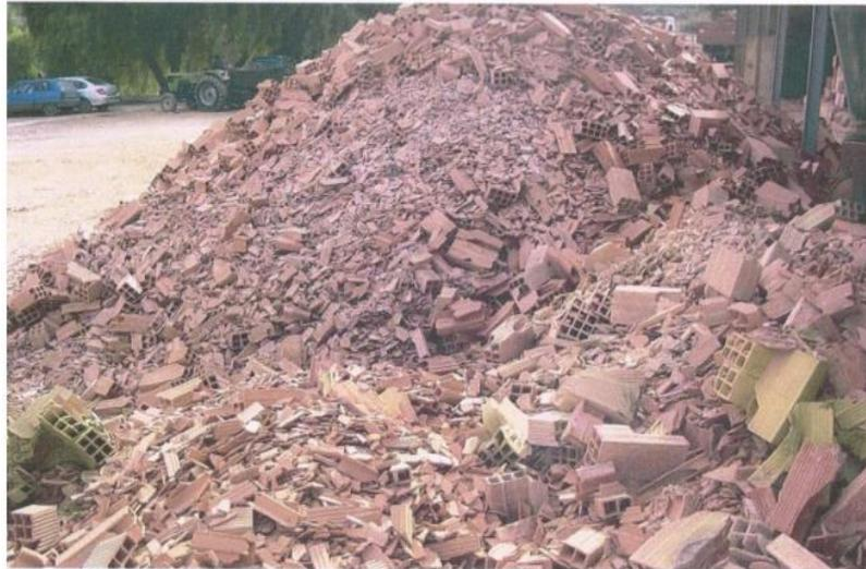
**Figure I. 11:** Déchets de brique de fabrication déposés aux alentours de la briquèterie [6]
