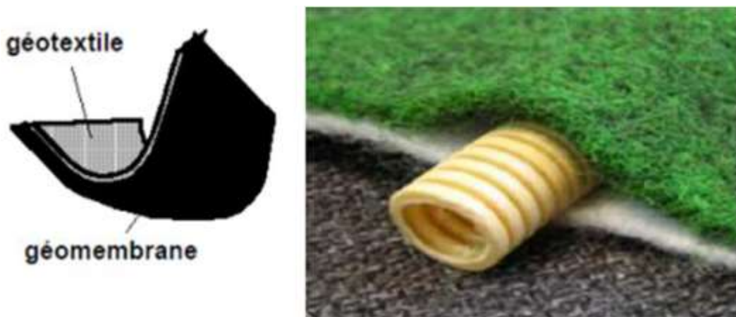
Figure III. 7: La structure d'un géo-composite [7].
