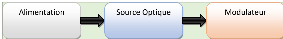
Figure I-2 Structure d'un émetteur optique.
