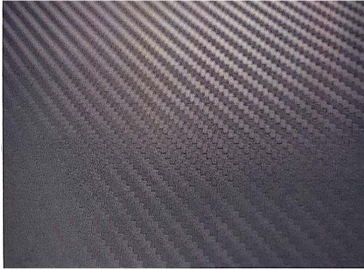
Figure III.1 Tissu de fibre de carbone
