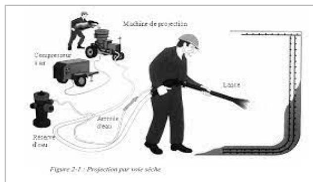
Figure I 7. Béton projeté par voie sèche
