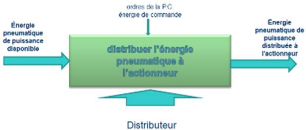
Figure 2.10. fonctionnement de Distributeur pneumatique
