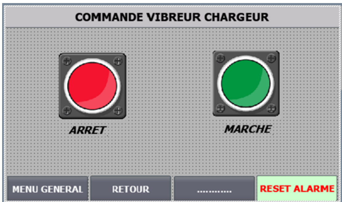
Figure 3.18. vue commande vibreur chargeur.
