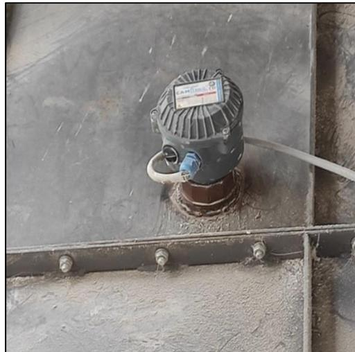
Figure 2.21 : Capteur de niveau dans notre chaîne
