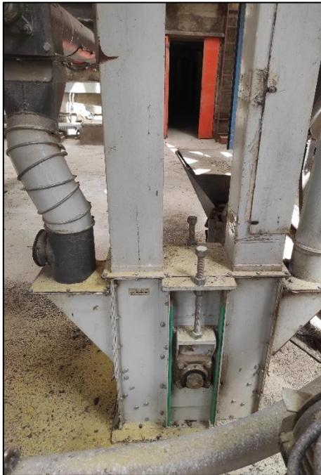
Figure 2.16 : Elévateur dans notre chaîne
