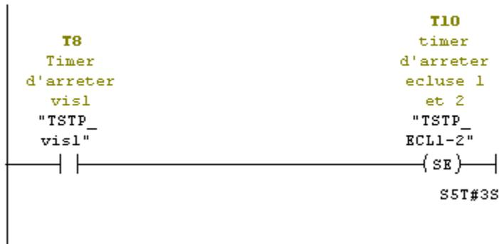
Figure 4.21 : Stop EC1 et EC2
