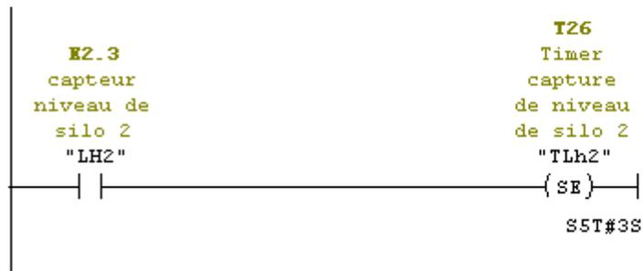
Figure 4.35 : Capteur de niveau 2
